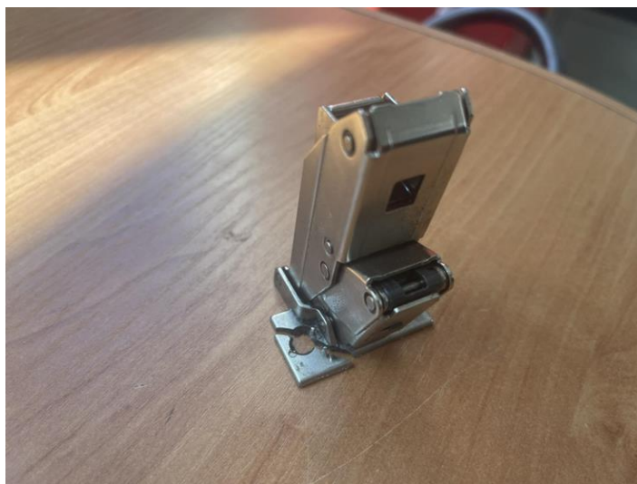
Rys. 5.8. Uszkodzenie zawiasu powstałe w badaniach trwałości
