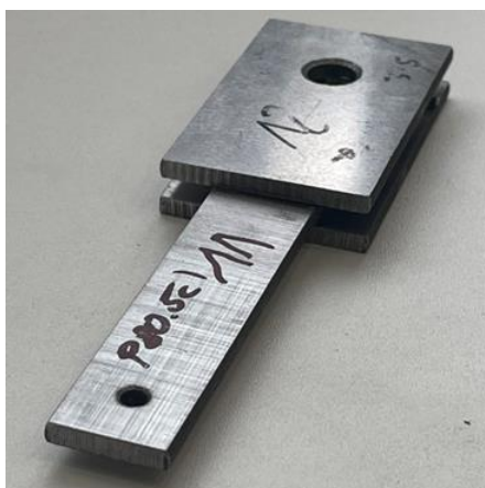
Rys. 4.3. Przykładowa próbka z połączeniem klejonym dwuzakładkowym – stal-stal
