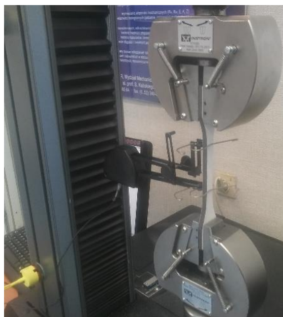
Rys. 3.5. Próbką wraz z ekstensometrem w uchwytach maszyny wytrzymałościowej INSTRON 5966
