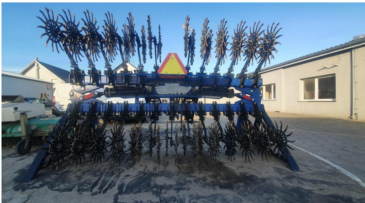
Fot. 2. Brona rotacyjna gwiazdowa stosowana do pielenia soi. Orekhovselmash BR-6g (Ukraina), źródło: fotografia własna
