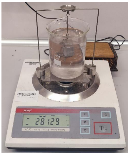
Rys. 5.8. Pomiar gęstości metodą hydrostatyczną. Urządzenie w trakcie pomiaru masy próbki: w powietrzu (a), w wodzie destylowanej (b)
