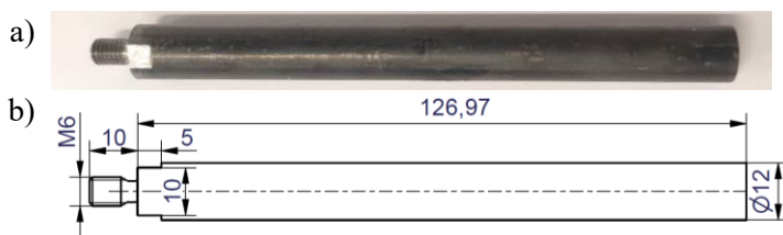
Rys. 4.6. Pręt kalibracyjny: a) widok, b) geometria
