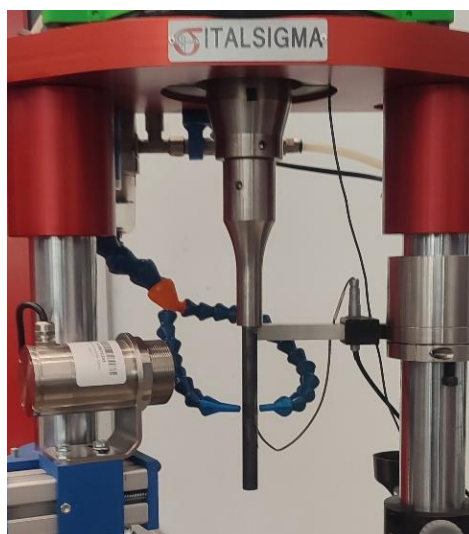
Rys. 4.7. Maszyna ultradźwiękowa w trakcie kalibracji
