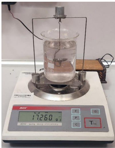
Rys. 5.8. Pomiar gęstości metodą hydrostatyczną. Urządzenie w trakcie pomiaru masy próbki: w powietrzu (a), w wodzie destylowanej (b)
