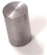
Rys. 5.7. Próbką do wyznaczania gęstości metodą hydrostatyczną
