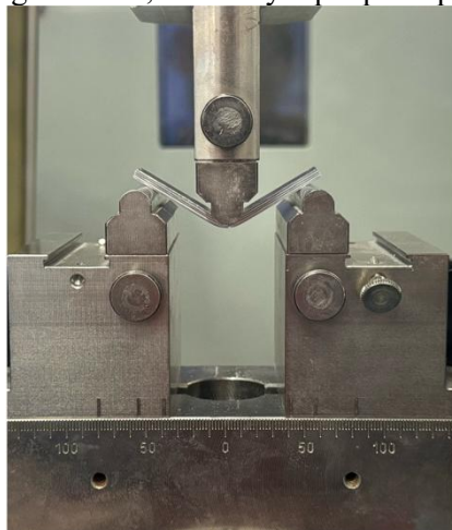
Rys. 4.8. Stanowisko badawcze do przeprowadzenia statycznej próby trójpunktowego zginania
