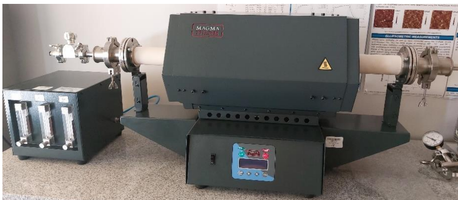
Rys. 6.6. Piec rurowy Magma Therm MTTF1100 z kontrolą czasu i temperatury oraz możliwością wygrzewania w wybranych gazach lub próżni
