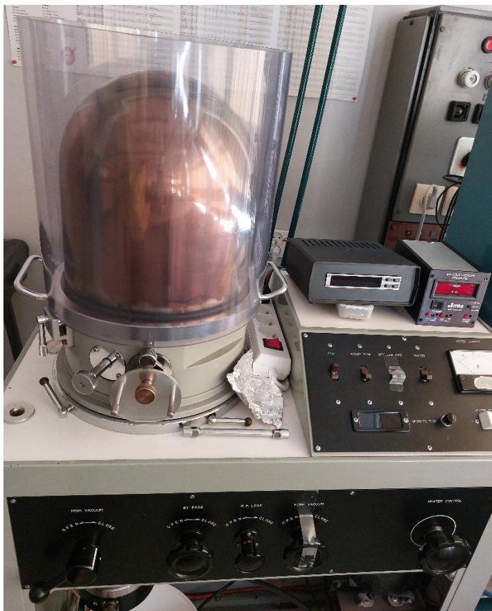
Rys. 6.5. Naparowywarka próżniowa JEOL JEE-4B (warunki półprzemysłowe)
