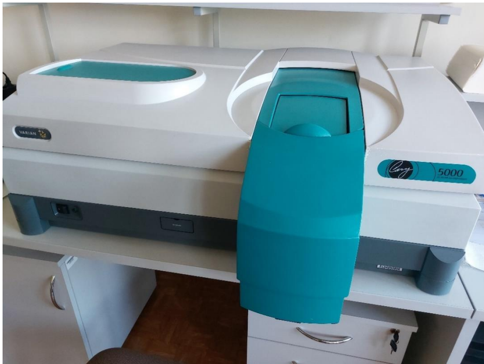
Rys. 7.5. Spektrofotometr Cary 5000 znajdujący się w Zakładzie Fizykochemii Powierzchni (Wydział Technologii i Inżynierii Chemicznej, Politechnika Bydgoska im. Jana i Jędrzeja Śniadeckich)
