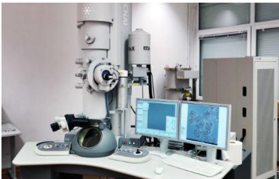
Rys. 7.4. Transmisyjny mikroskop elektronowy FEI G2 F20X-Twin 200 kV znajdujący się w Pracowni Analiz Instrumentalnych (Wydział Chemii, Uniwersytet Mikołaja Kopernika w Toruniu) [67]
