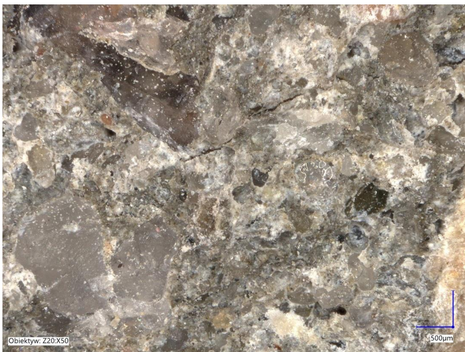
Rys. 77. Struktura petrograficzna próbki zagęszczanej metodą ręczną za pomocą młota wibracyjnego na statywie w powiększeniu 500 \mu\text{m} . Widoczne zaoblenia matrycy kruszywowo-cementowej. Zdjęcie autora.
