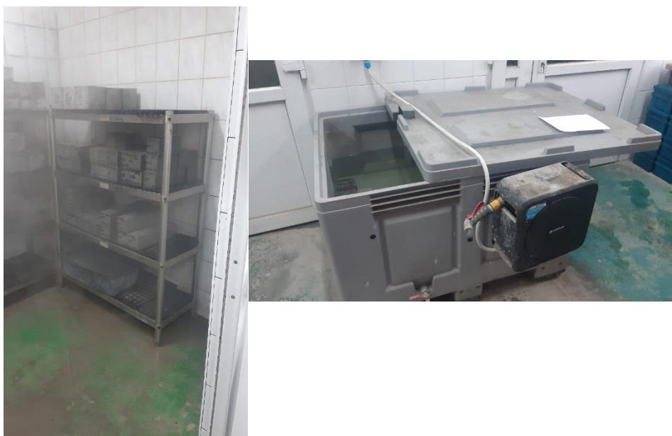
Rys. 37. Komora wilgotnościowa (lewe zdjęcie) do przechowywania próbek bezpośrednio po rozformowaniu oraz wanna (prawe zdjęcie) do przechowywania między 7 a 28 dniem dojrzewania. Zdjęcie autora.
