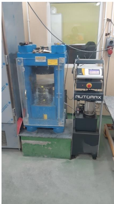
Rys. 38. Prasa hydrauliczna Controls do 3000 kN. Zdjęcie autora
