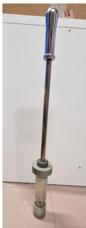
Rys. 34. Ubijak Proctora typu A o wadze 2,5 kg, wysokości spadu 300 mm i szklance o wymiarach 50,8 mm [95]. Zdjęcie autora.
