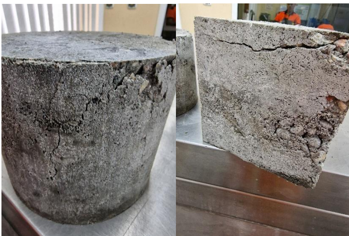
Rys. 65. Próbkki po zniszczeniu. Po lewej stronie próbka walcowa z metody Proctora, po prawej próbka sześcienna z metody zagęszczania młotem wibracyjnym autorską metodą. Zdjęcie autora.
