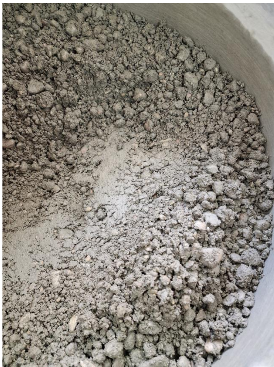
Rys. 8. Konsystencja mieszanki betonowej w wilgotności optymalnej. Zgodnie z badaniem Ve-Be [17] określono wartość V0. Zdjęcie autora
