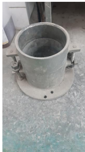
Rys. 32. Automatyczny aparat Proctora wraz z cylindryczną formą stalową 120x150 mm – forma B wg [95]. Zdjęcie autora.
