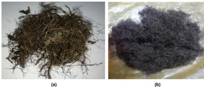
Rys 10. Włókna gumowe, przed przetworzeniem (a), po przetworzeniu (b) [34].
