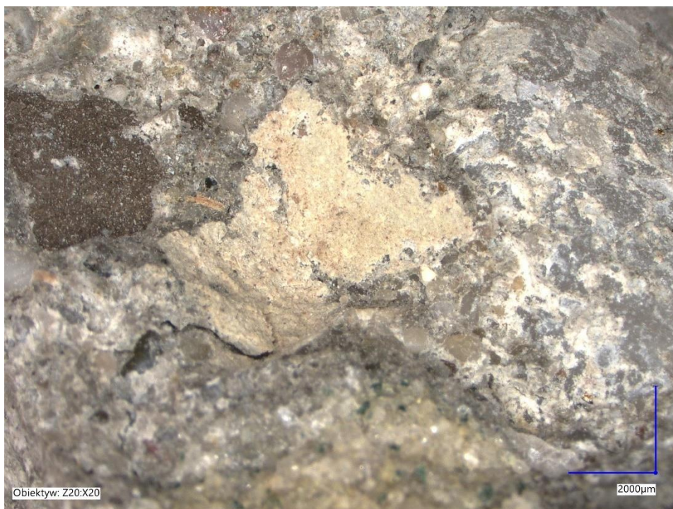
Rys. 76. Struktura petrograficzna próbki zagęszczanej metodą ręczną za pomocą młota wibracyjnego w powiększeniu 2000 \mu\text{m} . Widoczne zaoblenia matrycy kruszywowo-cementowej. Zdjęcie autora.
