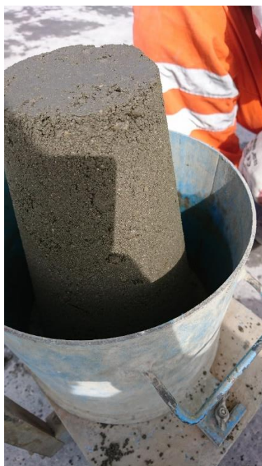
Rys 9. Przygotowany stożek do badania konsystencji metodą Ve-Be. Zdjęcie autora.
