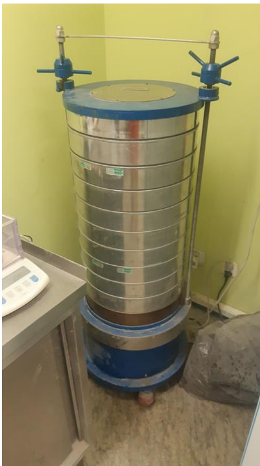
Rys. 25. Zestaw sit, drgania: pionowo – skrętne; amplituda: regulowana 0 - 2,5 mm; częstotliwość drgań: stała 50 Hz; czas przesiewania: regulowany 0 - 99 min (10 min+dosiewanie). Zdjęcie autora.
