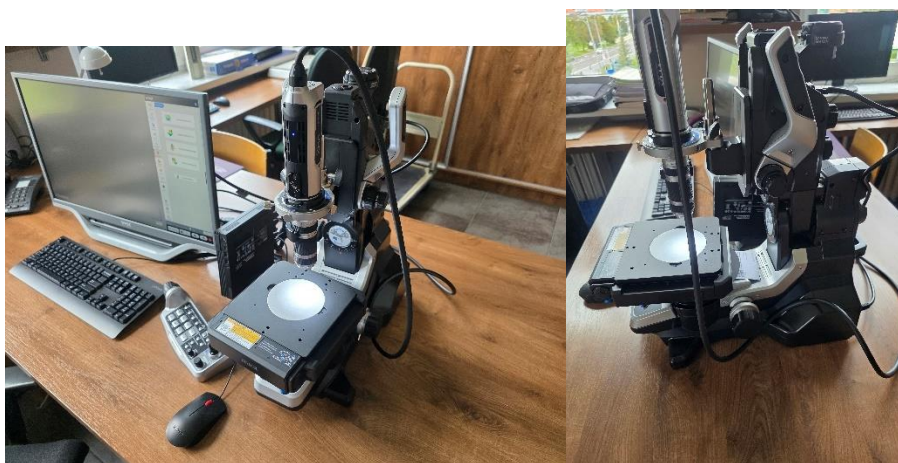
Rys. 39. Stanowisko badawcze mikroskop KEYENCE model VHX-X1F. Zdjęcie autora.
