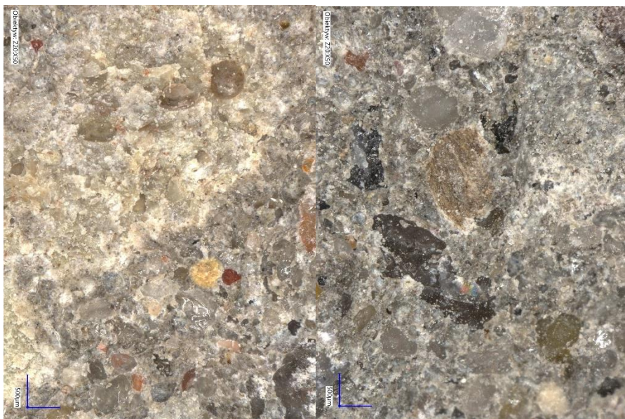
Rys. 57. Widok struktury betonu zagęszczanego metodą ręczną. Zdjęcie autora.
