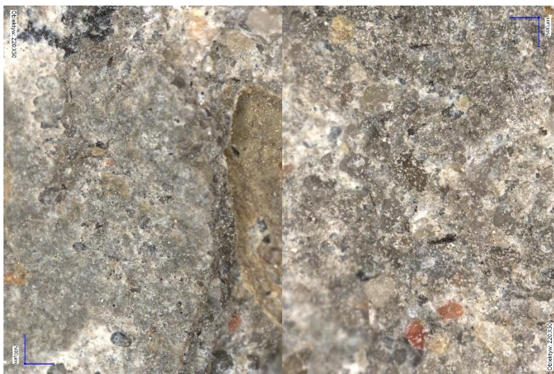
Rys. 56. Widok struktury betonu zagęszczonego metodą Proctora. Zdjęcie autora.
