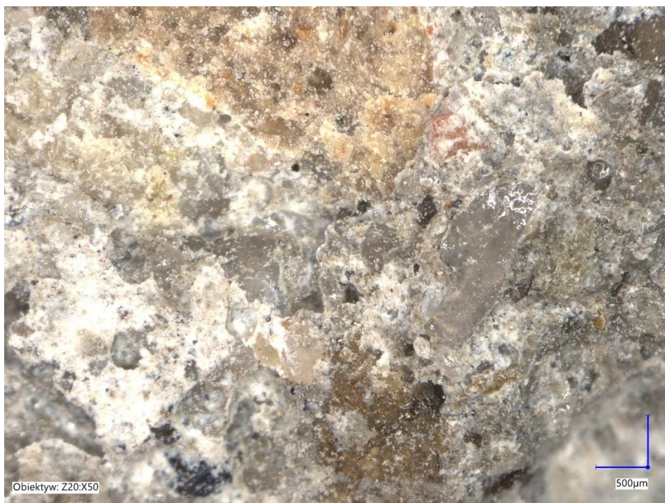
Rys. 75. Struktura petrograficzna próbki zagęszczanej metodą Proctora. w powiększeniu 500 \mu\text{m} . Widoczna ostrokrawędzista, spękana, zbita matryca. Zdjęcie autora.
