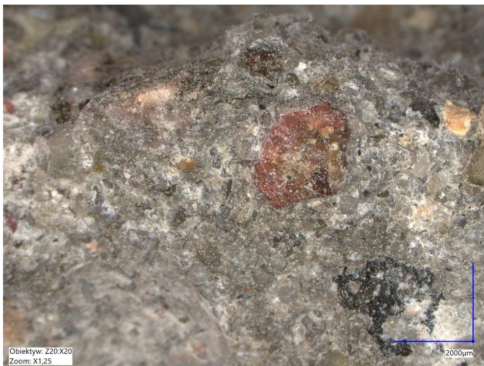
Rys. 74. Struktura petrograficzna próbki zagęszczanej metodą Proctora. w powiększeniu 2000 \mu\text{m} . Widoczna ostrokrawędzista, zbita matryca. Zdjęcie autora.
