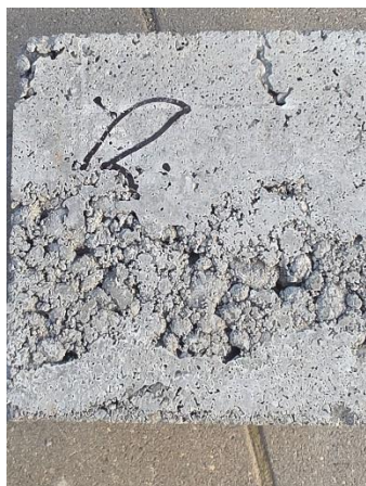
Rys. 67. Próbka użyta do obserwacji struktury makroskopowej po przecięciu, zagęszczana metodą autorską. Zdjęcie autora.
