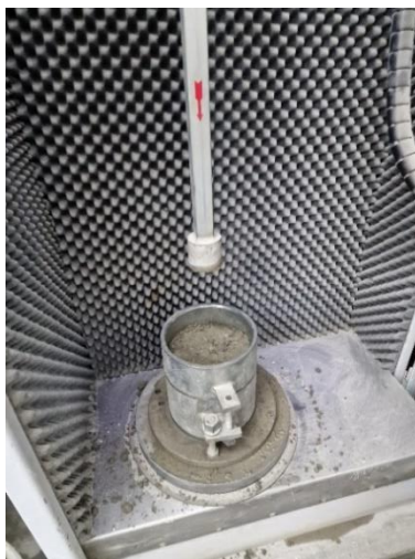
Rys. 32. Automatyczny aparat Proctora wraz z cylindryczną formą stalową 120x150 mm – forma B wg [95]. Zdjęcie autora.
