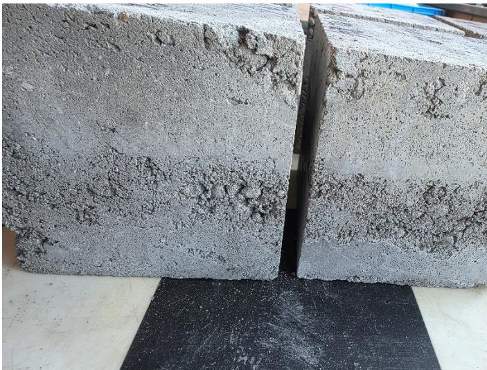
Rys. 64. Próbkki zagęszczane młotem vibracyjnym. Wyraźne odcięcie warstwy na poboczniczy przy wykonywaniu warstwy szczepnej. Zdjęcie autora
