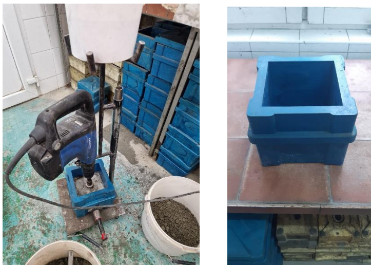
Rys. 33. Młot wibracyjny wraz ze stopą do zagęszczania ręcznego (zdjęcie do podmiany) i forma do przygotowania próbki sześcienniej 150x150x150 mm. Zdjęcie autora.
