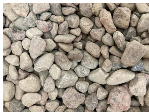
Rys. 17. Kruszywo grube frakcji 8/16 mm - Żwirownia Sępólno Wielkie. Zdjęcie autora
