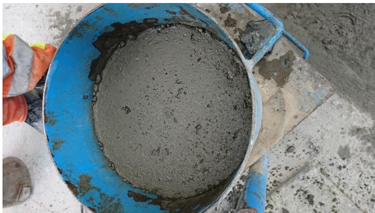
Rys. 28. Rozpływ materiału metodą Ve-Be po zakończeniu badania. Zdjęcie autora.
