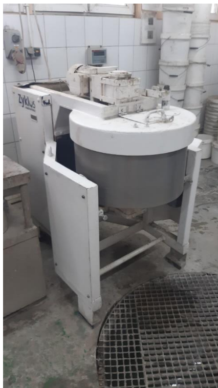
Rys. 27. Mieszalnik Pemat ZK 50 HE, moc 2,37 kW, 50Hz, maksymalny załadunek 80 kg. Zdjęcie własne.
