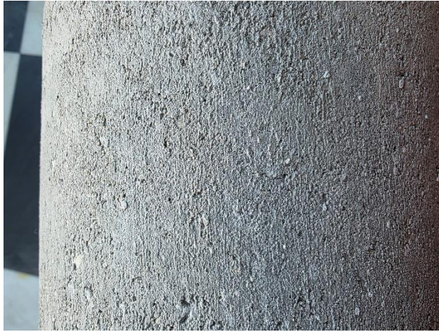
Rys. 63. Struktura próbki zagęszczanej metodą Proctora o wymiarach 150x120 mm (dxh). Zdjęcie autora
