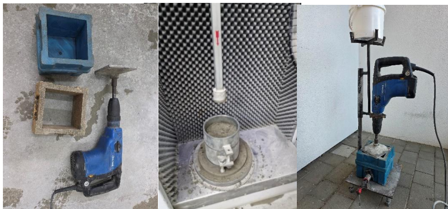
Rys. 36. Narzędzia do metodyki zagęszczania – od lewej – metoda ręczna za pomocą młota wibracyjnego, w środku metoda Proctora automatyczna, z prawej metoda autorska wraz ze statywem.
