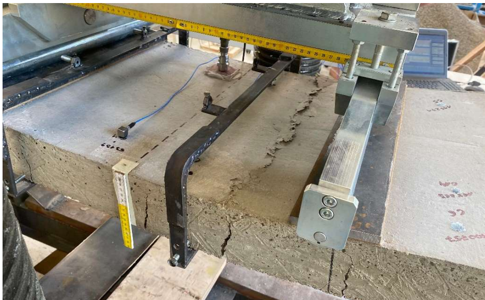
Rys. 40. Obraz zniszczenia płyty o małym stopniu zbrojenia.
