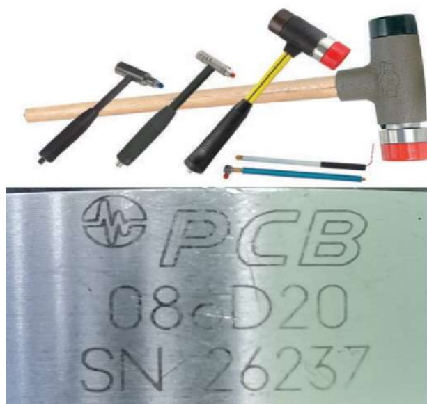
Rys. 34. Model młotka modalnego zastosowany w eksperymencie.
