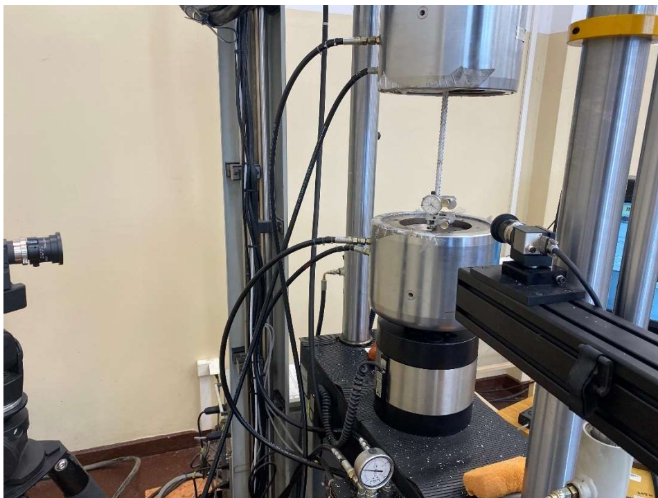
Rys. 2. Widok zbrojenia w trakcie próby rozciągania w maszynie Instron z zastosowaniem technologii „digital image correlation”.
