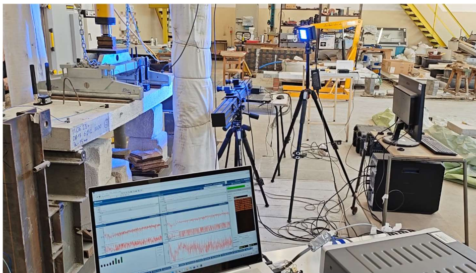
Rys. 56 System pomiarowy (u dołu system SCADA LMS Siemens analizy dynamicznej, z prawej DIC – Zeiss wraz z kamerami 3D: system cyfrowej korelacji obrazu) – płyty GFRP.
