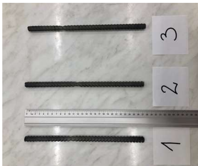
Rys. 38. Obraz zniszczenia stali zbrojeniowej #10 B600B.
