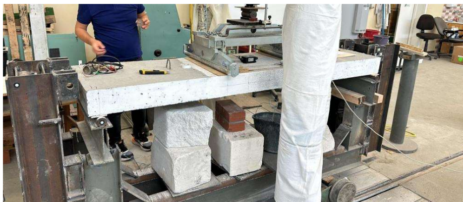
Rys. 14. Widok stanowiska z płytą zbrojoną GFRP przed rozpoczęciem badania.
