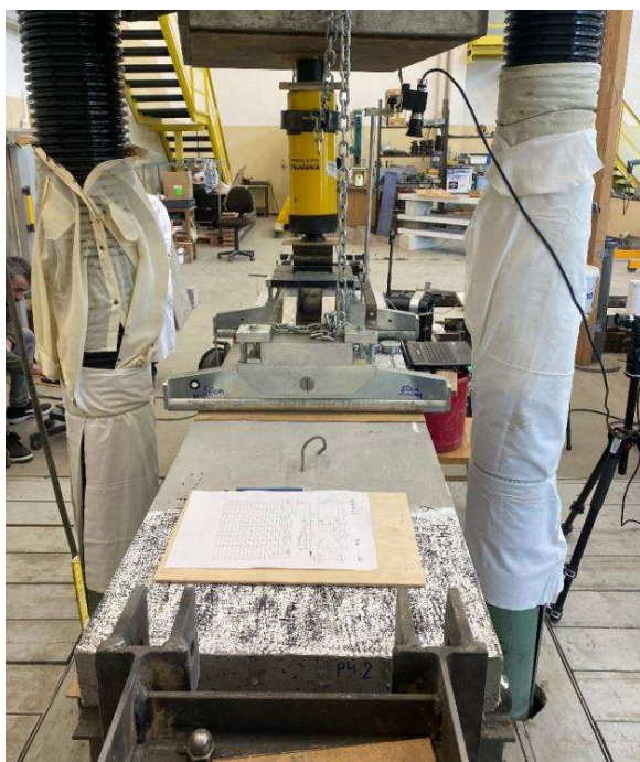
Rys. 15. Widok stanowiska podczas badań płyty z zbrojeniem GFRP.
