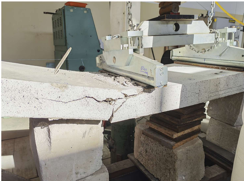
Rys.52. Obraz zniszczenia – płyta K100-2.
