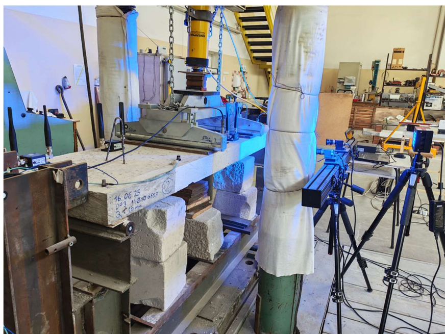
Rys. 16. Widok stanowiska podczas badań płyty z zbrojeniem GFRP.
