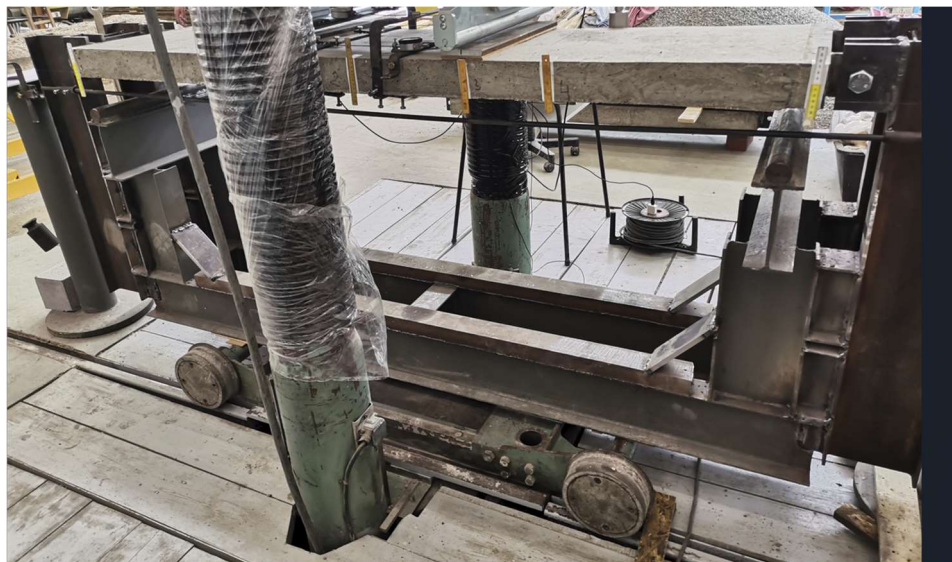
Rys. 6. Widok stanowiska badawczego z zamocowaną płytą zbrojoną B600B.
