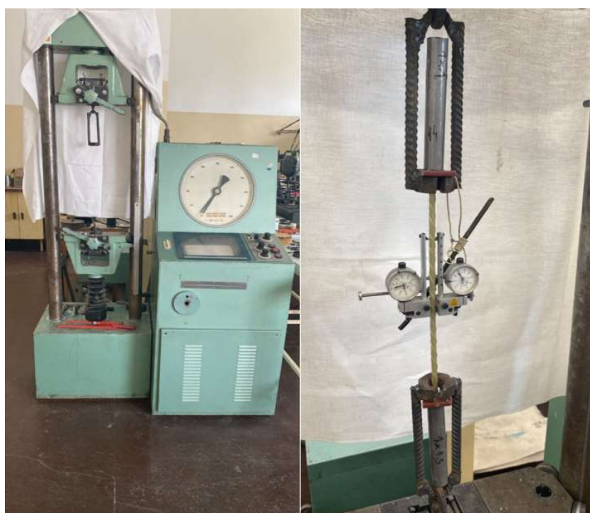
Rys. 1. Widok zbrojenia w trakcie próby rozciągania w maszynie typ VEB.
