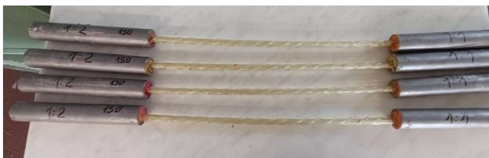
Rys. 37. Zbrojenie GFRP poddane badaniu.
