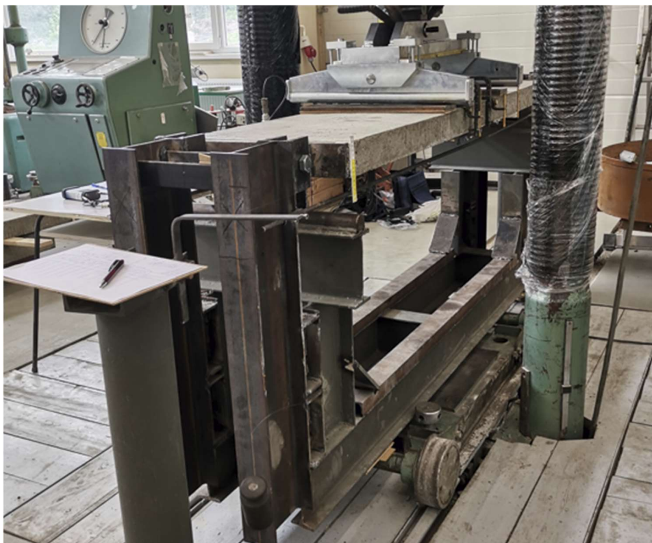
Rys. 7. Widok stanowiska badawczego z zamocowaną płytą zbrojoną B600B.
