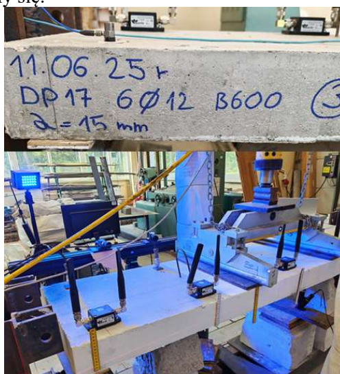
Rys. 32. Płyta S 100-4 w trakcie badania.
