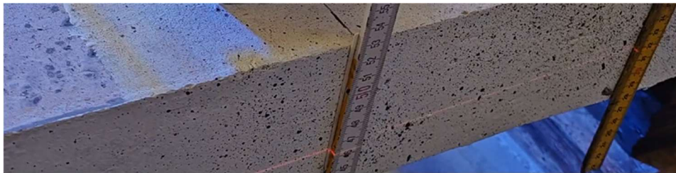
Rys. 54. Pomiar ugięcia płyt GFRP.
