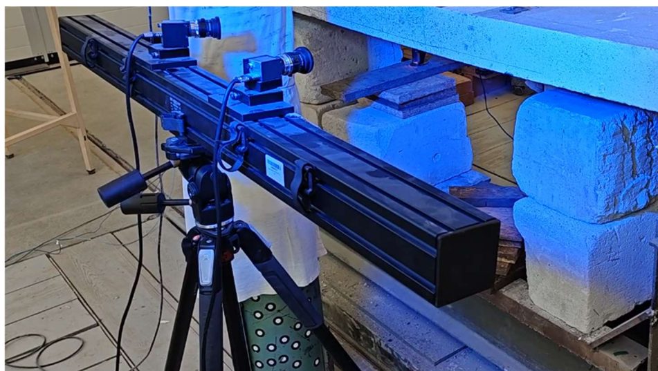
Rys. 57. System pomiarowy – kamery 3D – płyty GFRP.
