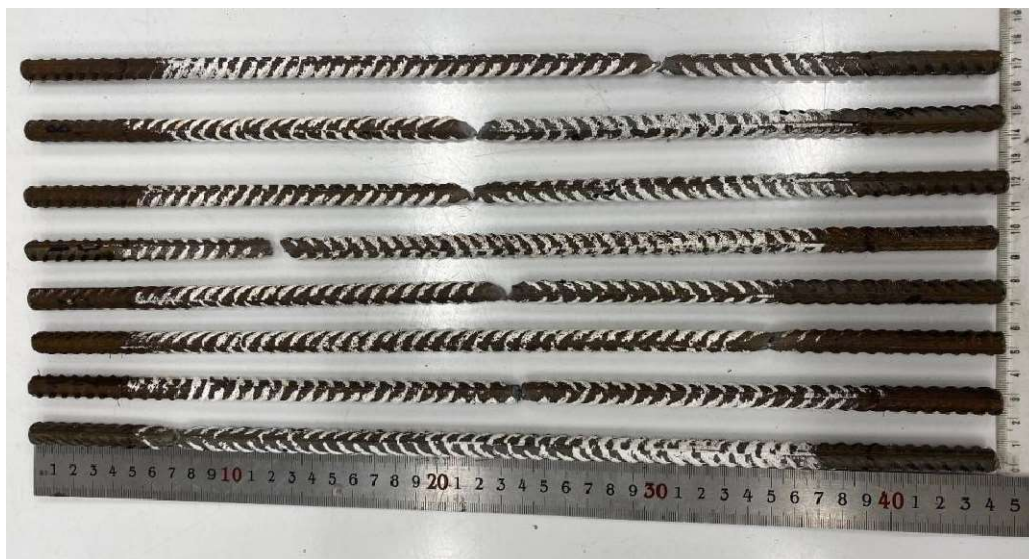
Rys. 39. Widok prętów po zniszczeniu w badaniu przeprowadzonych z zastosowaniem urządzenia Instron 8502 oraz systemu CKO (cyfrowej korelacji obrazu).
