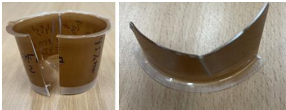
Rys. 81. Obrazy wyprasek PP/R 1 (PP+EVOH)/PP z lokalnie występującymi obszarami zabielenia przekrojów ścianek, które powstały na skutek oddziaływania współpracujących noży tnących w procesie cięcia. Postać uszkodzeń wskazuje na dominującą rolę naprężeń ścinających w podziale trójwarstwowej nadawy
