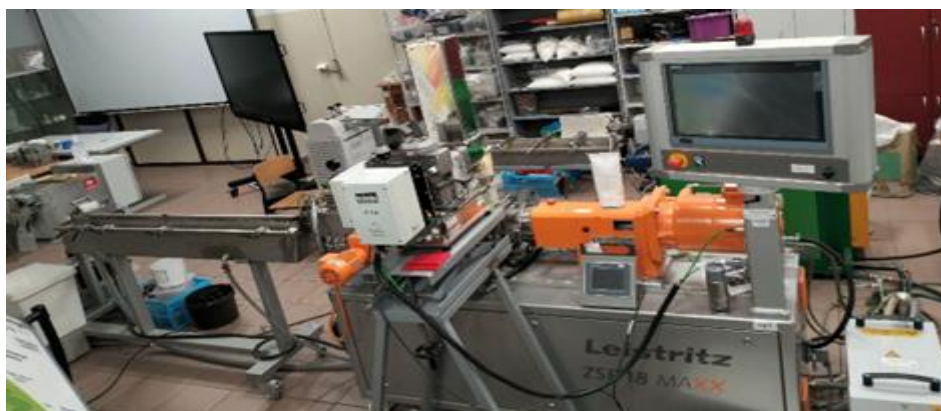
Rys. 22. Widok linii do wytłaczania regranulującego recyklatów otrzymanych przez rozdrobnienie trójwarstwowych wyprasek PP/EVOH/PP. Na pierwszym planie wytłaczarka dwuślimakowa Leistritz ZSE18 MAXX z układem sterującym i dozownikiem
