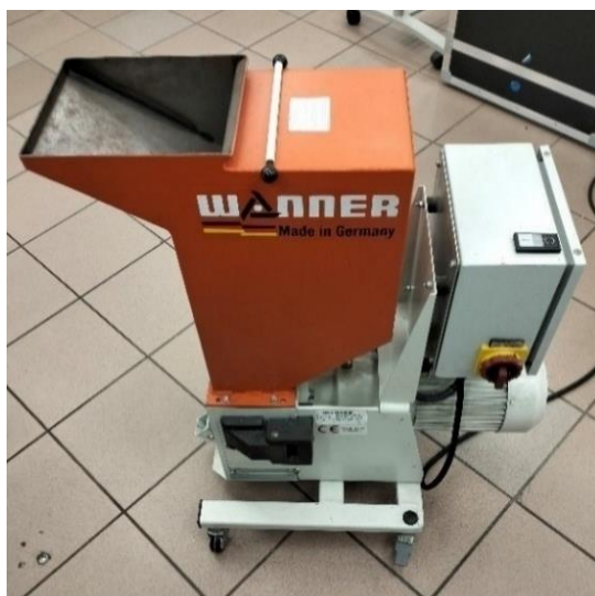
Rys. 21. Wolnoobrotowy młyn walcowy zastosowany do wstępnego rozdrobnienia trójwarstwowych wyprasek PP/EVOH/PP - laboratorium Katedry Technik Wytwarzania Politechniki Bydgoskiej
