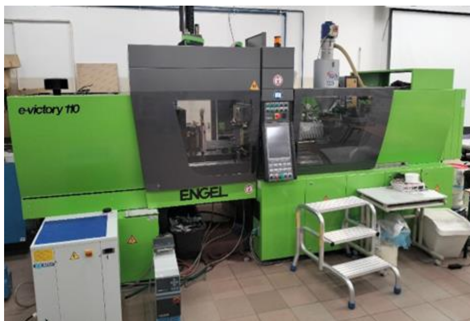
Rys. 23. Stanowisko badawcze do wytwarzania znormalizowanych kształtek badawczych z regranulatu R(PP+EVOH) oraz PP
