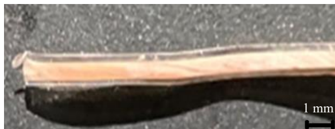
Rys. 49. Przykładowy wycinek poprzeczny ścianki wypraski PP/R 1 (PP+EVOH)/PP o grubości 1 mm, przeznaczony do wstępnej oceny zawartości rdzenia i relacji między warstwami w warunkach przemysłowych
