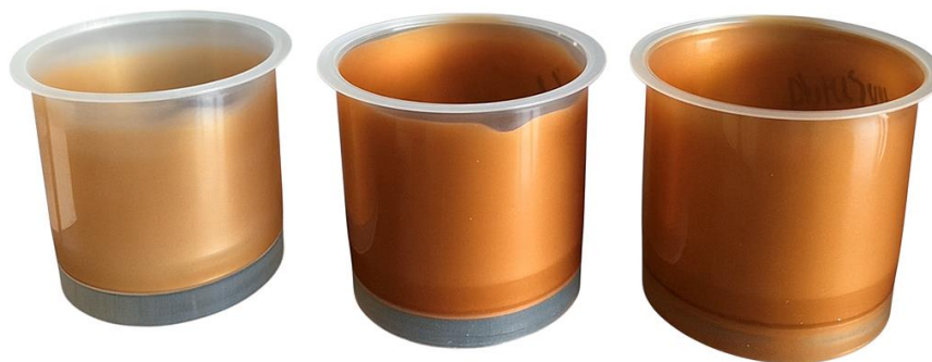
Rys. 46. Widok przykładowych trójwarstwowych opakowań, zawierających warstwę zewnętrzną oraz wewnętrzną z PP oraz rdzeń z regranulatu R_1(\text{PP}+\text{EVOH})
