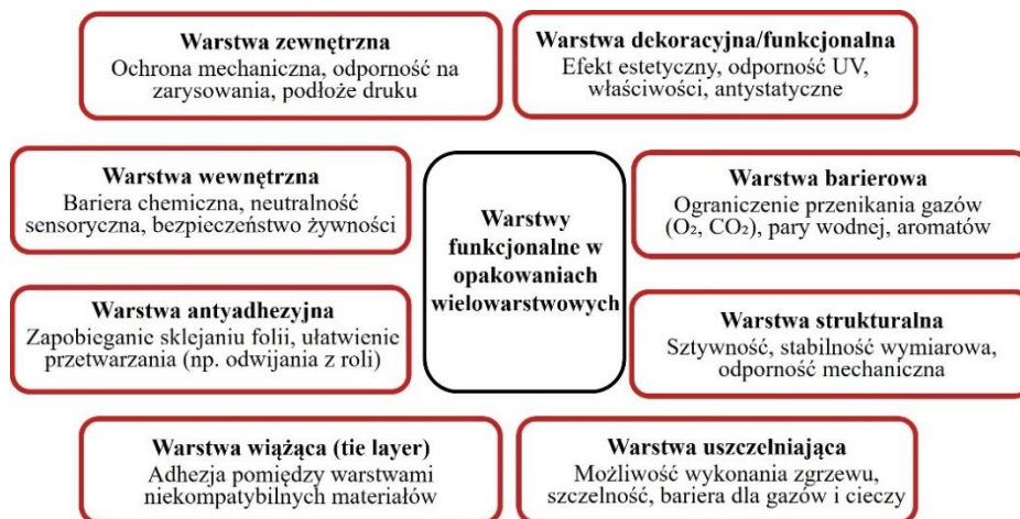
Rys. 14. Warstwy funkcjonalne stosowane w produkcji opakowań wielowarstwowych. Opracowanie własne
