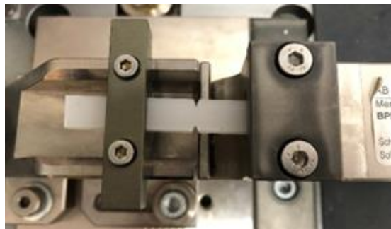
Rys. 29. Widok próbki R(PP+EVOH) zamocowanej w uchwycie przed realizacją próby oznaczenia wytrzymałości na udarowe rozciąganie
