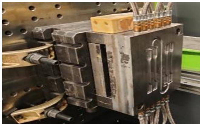
Rys. 24. Widok laboratoryjnej formy wtryskowej, zastosowanej do wytwarzania znormalizowanych kształtek badawczych z regranulatu R(PP+EVOH) oraz PP
