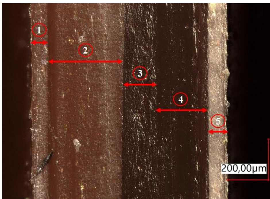
Rys. 63. Przykładowy obraz rozkładu grubości warstw w przekroju ścianki bocznej wypraski PP/R 1 (PP+EVOH)/PP, wytworzonej z czasem opóźnienia rozpoczęcia wtrysku regranulatu 0,2 sekundy. Obraz zarejestrowano w odległości 20 mm od kołnierza (po lewej warstwa zewnętrzna – oznaczenie (1), po prawej warstwa wewnętrzna wypraski – oznaczenie (5))
