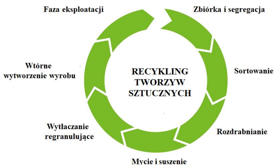
Rys. 18. Schemat procesów składowych recyklingu mechanicznego opakowań z tworzyw termoplastycznych. Opracowanie własne
