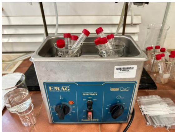
Rys.3.10. Stanowisko do prowadzenia procesu trawienia próbek typu ZU
