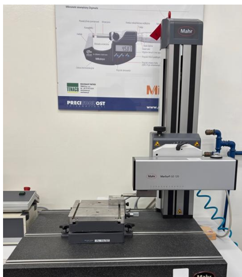
Rys.3.15. Stanowisko do pomiaru chropowatości – profilografometr Mahr MarSurf GD 120
