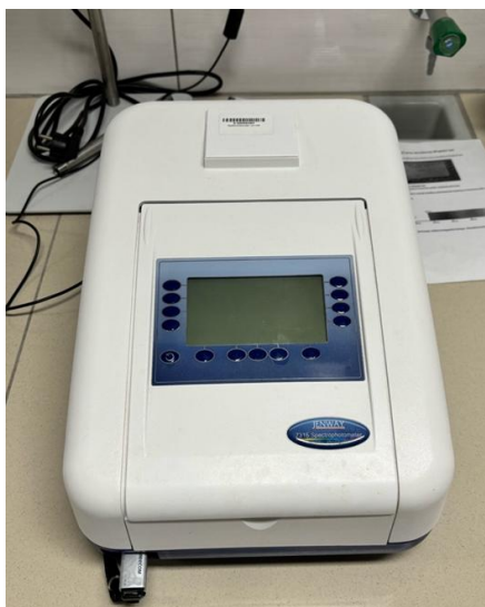
Rys.3.20. Stanowisko do pomiaru widma UV-Vis – spektrofotometr Jenway 7315
