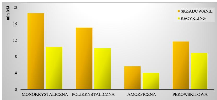
Rys. 5.103. Charakteryzowanie zapotrzebowania na energię w cyklu istnienia paneli PV badanych elektrowni fotowoltaicznych z uwzględnieniem odmiennych scenariuszy zagospodarowania poużytkowego (model CED, jednostka: mln MJ)
