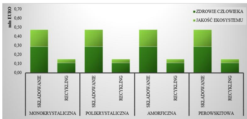
Rys. 5.87. Grupowanie i ważenie następstw środowiskowych dla zdrowia człowieka i jakości ekosystemów w cyklu istnienia stacji inwerterowych badanych elektrowni fotowoltaicznych z uwzględnieniem odmiennych scenariuszy zagospodarowania użytkowego (model IMPACT World+, jednostka: mln EURO)
