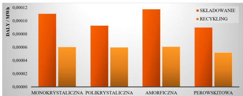
Rys. 5.115. Charakteryzowanie następstw środowiskowych dla zdrowia człowieka w cyklu istnienia badanych elektrowni fotowoltaicznych z uwzględnieniem odmiennych scenariuszy zagospodarowania poużytkowego (model IMPACT World+, jednostka: DALY/MWh)
