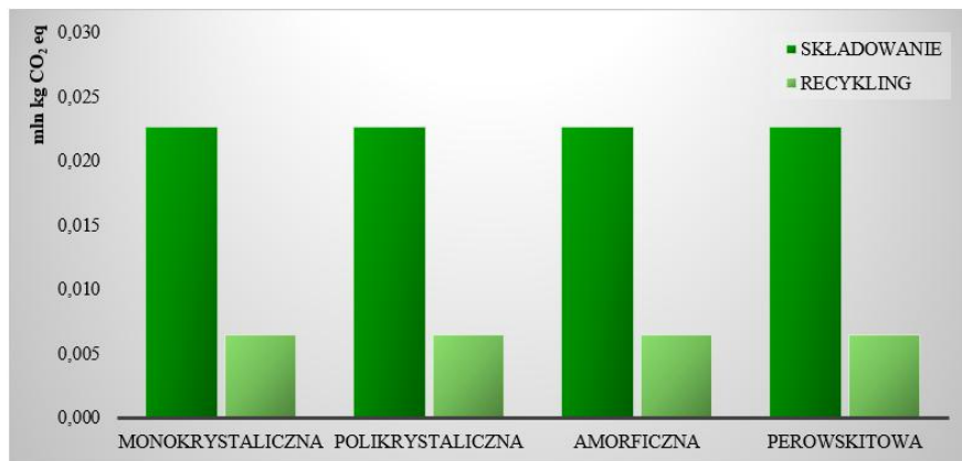
Rys. 5.94. Charakteryzowanie następstw środowiskowych dla emisji gazów cieplarnianych w cyklu istnienia stacji inwerterowych badanych elektrowni fotowoltaicznych z uwzględnieniem odmiennych scenariuszy zagospodarowania użytkowego (model IPCC 2021, jednostka: mln kg CO 2 eq)
