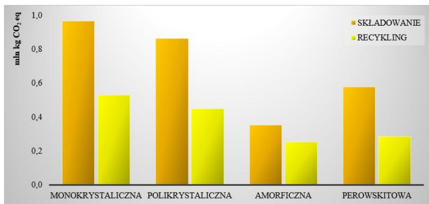
Rys. 5.93. Charakteryzowanie następstw środowiskowych dla emisji gazów cieplarnianych w cyklu istnienia paneli PV badanych elektrowni fotowoltaicznych z uwzględnieniem odmiennych scenariuszy zagospodarowania poużytkowego (model IPCC 2021, jednostka: mln kg CO 2 eq)
