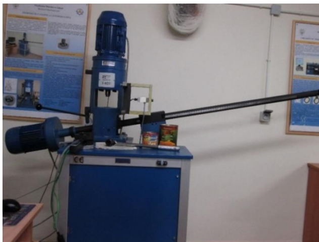
Rys. 14. Ogólny widok aparatu czterokulowego T-02U. Opracowanie własne
