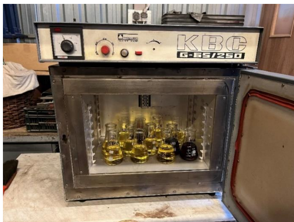
Rys. 19. Komora badań cieplnych KBC G-65/250 firmy Premed. Opracowanie własne
