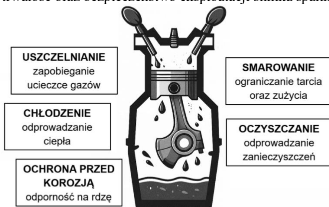
Rys. 1. Podstawowe funkcje oleju w silniku spalinowym [1]
