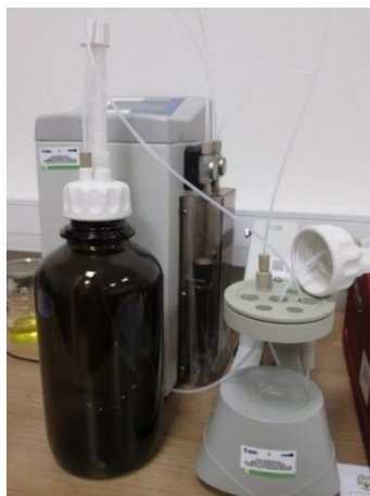
Rys. 17. Tytrator potencjometryczny do pomiaru liczby zasadowej. Opracowanie własne
