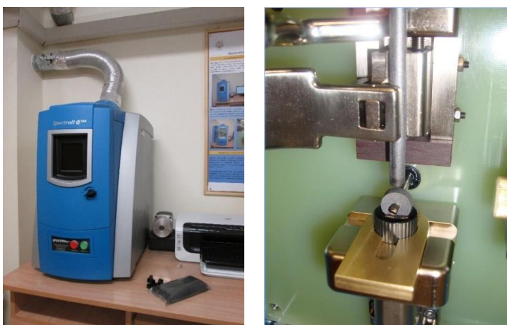
Rys. 15. Na rysunku od lewej znajdują się: ogólny widok spektrometru Spectroil Q100 oraz wewnątrz urządzenia z rotacyjną elektrodą dyskową. Opracowanie własne
