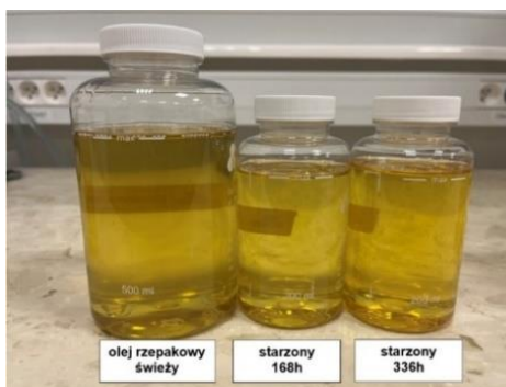
Rys. 30. Porównanie próbek oleju rzepakowego przed i po starzeniu termicznym przez 168 h i 336 h
