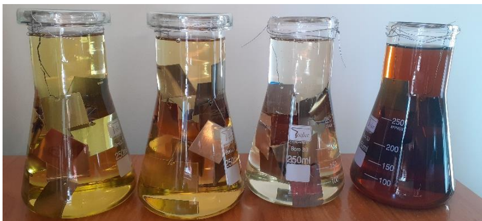
Rys. 45. Kolby wypełnione metalowymi płytkami i badanymi olejami (od lewej olej rzepakowy, olej lniany, olej rycynowy, Marinol RG 1240) – przed podgrzaniem. Opracowanie własne
