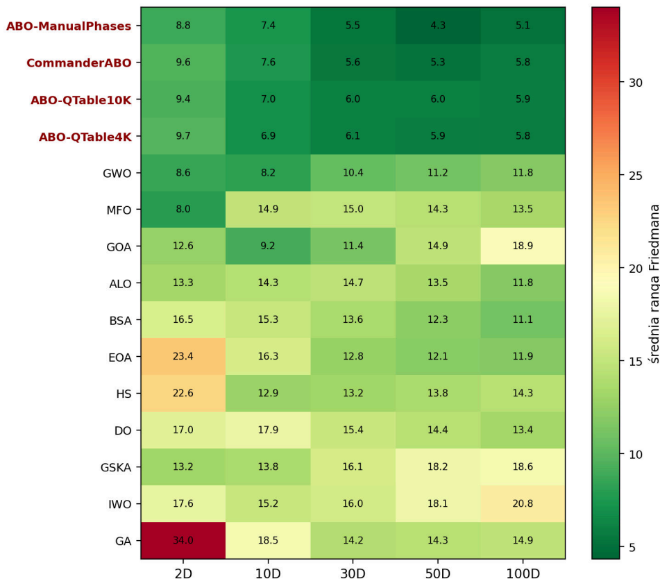
Rys. 36. Mapa skalowalności – średnia ranga Friedmana (top-15 z pełnego rankingu 46 algorytmów) w zależności od wymiarowości. Rodzina ABO zajmuje czołowe pozycje w wymiarach 10D–100D; w tym zakresie prowadzi ABO-ManualPhases, a CommanderABO plasuje się tuż za nim (2. pozycja w 30D–100D). W 2D dominują algorytmy klasyczne (MFO, ABC, GWO), a warianty ABO ustępują – architektura heterogeniczna nie zwraca się w niskich wymiarach, lecz daje wyraźną przewagę od 10D w górę.
