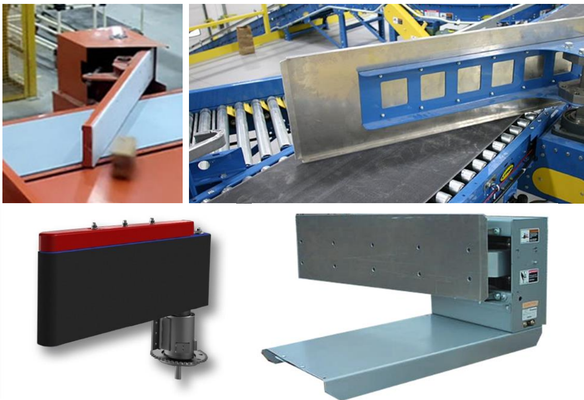
Rys. 2. Przykłady istniejących rozwiązań konstrukcyjnych zastawy
