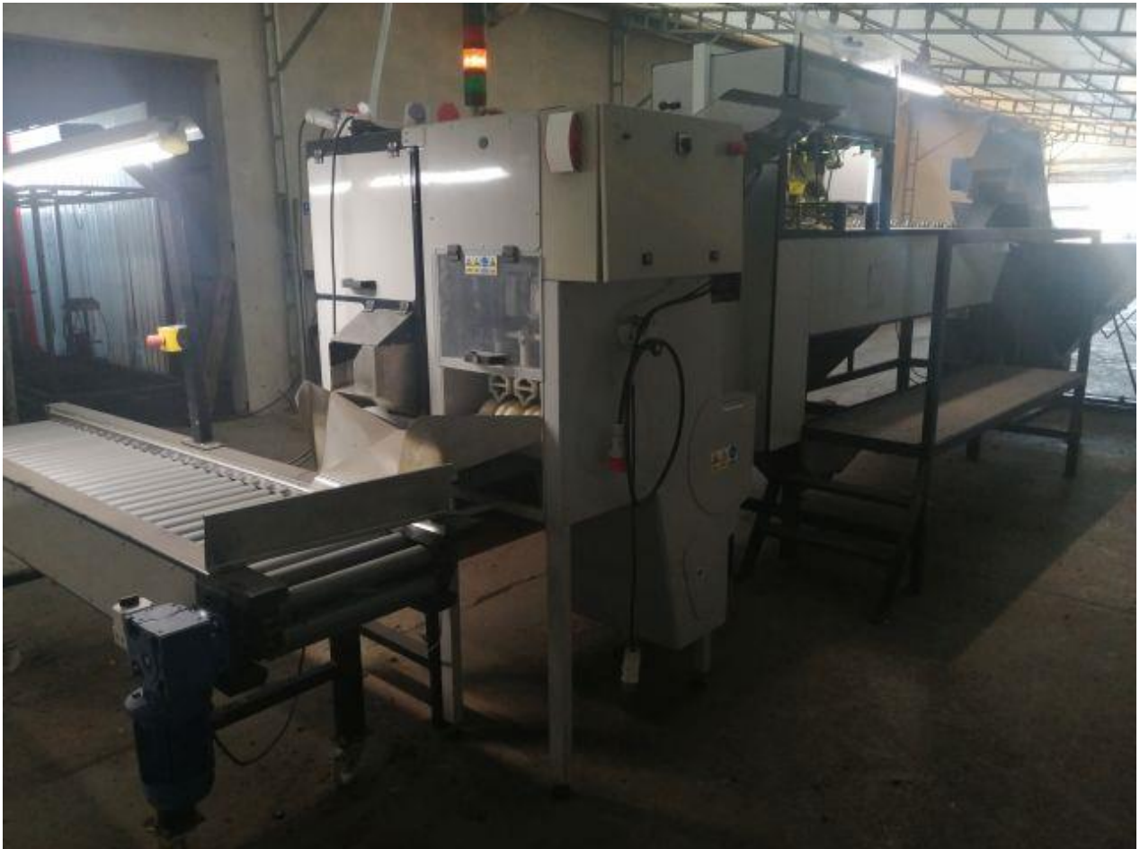
Rys. 6. Stanowisko badawcze – maszyna do obierania cebuli zaprojektowana i zbudowana przez autora rozprawy
