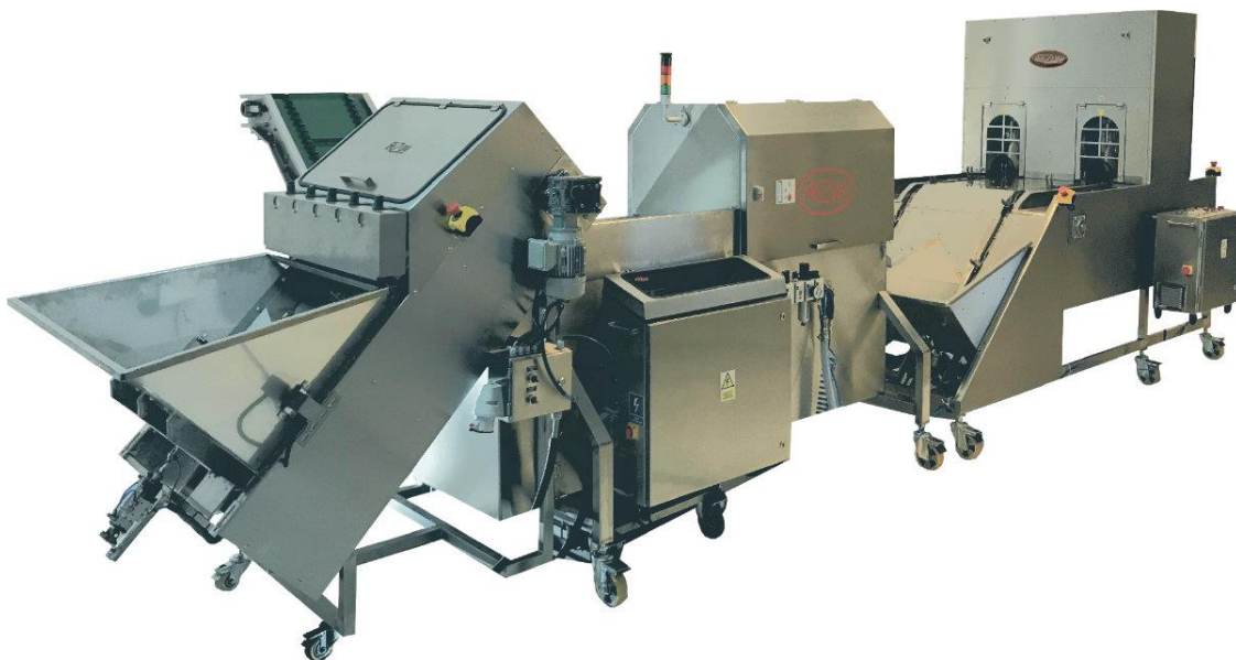
Rys. 3. Maszyny do obierania cebuli Imizumi ( Oferta | Producent maszyn do obierania cebuli IMIZUNI )
