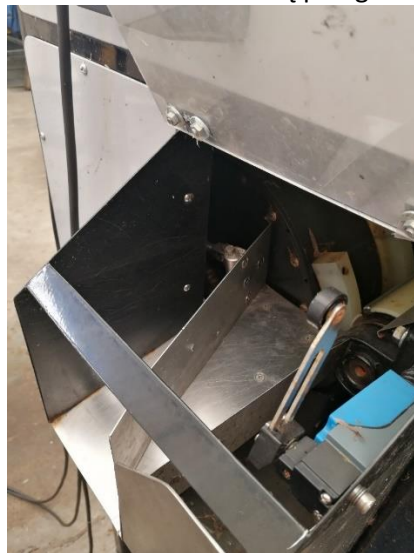
Rys. 22. Elementy wykonawcze układu selekcji cebul niespełniających wymagań jakościowych.
