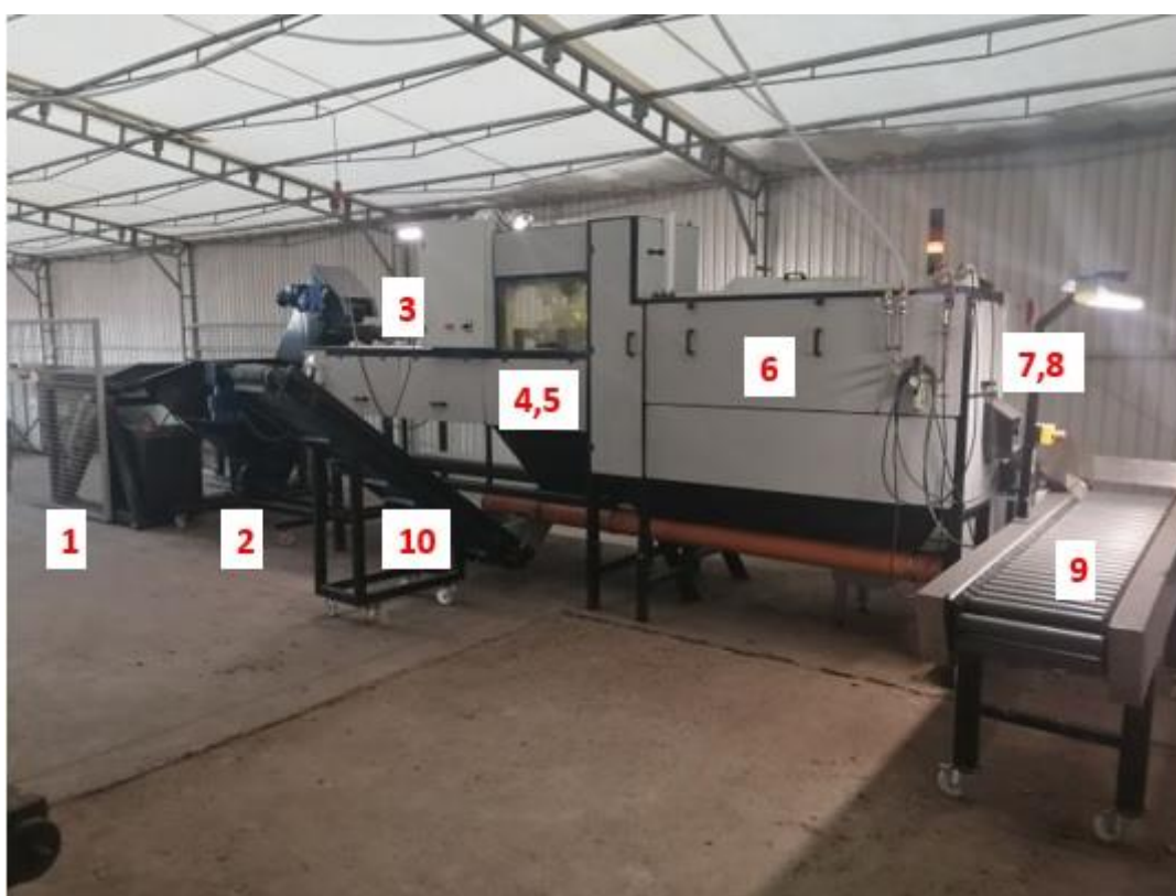
Rys. 7. Schemat funkcjonalny maszyny do obierania cebuli będącej obiektem badań: 1- wywrotnica skrzyniopalet, 2 – podajnik materiału, 3 – przeñośnik zabierakowy, 4 – układ obcinania końcówek, 5 – układ nacinania łuski, 6 – układ zdmuchiwania łuski, 7 – układ wizualnej kontroli jakości, 8 – układ dokonujący poprawek, 9 – stół inspekcyjny, 10 – układ usuwania odpadów
