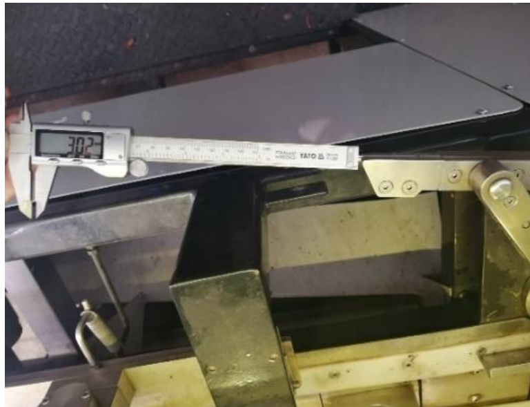
Rys. 15. Sposób wyznaczania głębokości nacięć zewnętrznych warstw łusek
