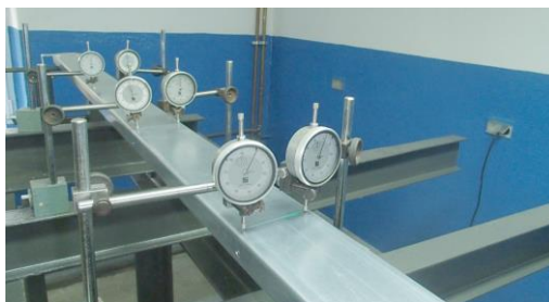
Rys. 8.3. Widok ogólny stanowiska badawczego: a) profil C140 z widocznym haczykiem do podwieszania obciążenia b) ułożenie zegarowych czujników pomiarowych na badanym profilu cienkościennym C140.
