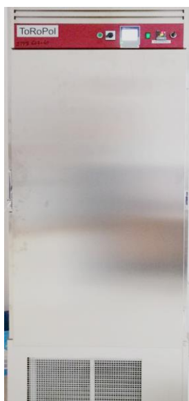
Rys. 9.3. Komora klimatyczna ToRoPol Binder: a) widok od zewnątrz, b) widok wnętrza komory z umieszczonymi próbkami.
