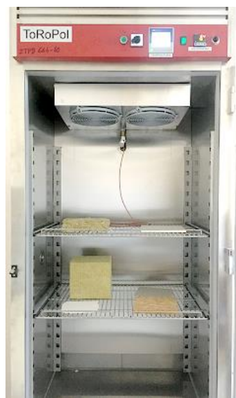
Rys. 9.3. Komora klimatyczna ToRoPol Binder: a) widok od zewnątrz, b) widok wnętrza komory z umieszczonymi próbkami.
