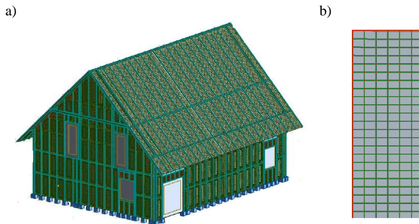
Rys. 7.1. Model obliczeniowy konstrukcji budynku: a) siatka MES dla modelu obliczeniowego budynku piętrowego wykonanego z profili C140, b) metoda siatkowania Coonsa.
