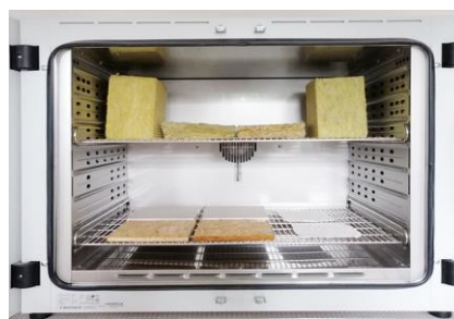
Rys. 9.2. Komora temperaturowa Binder: a) widok od zewnątrz, b) widok wnętrza komory z umieszczonymi próbkami.
