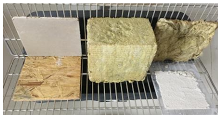
Rys. 9.4. Odsączanie próbek poddanych badaniu nasiąkliwości.
