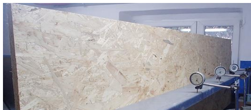
Rys. 8.5. Widok ogólny stanowiska badawczego dla oceny przemieszczeń pionowych profilu C140 z uwzględnieniem poszycia płytą OSB oraz widocznym ułożeniem czujników pomiarowych.
