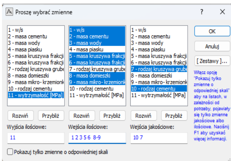
Rysunek 6.12. Wybór wektora wejścia oraz wyjścia
