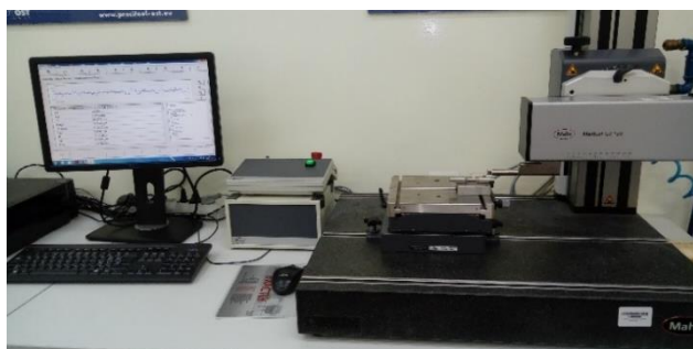
Rys. 3.10. Stanowisko do pomiaru chropowatości powierzchni Mahr MarSurf GD 120
