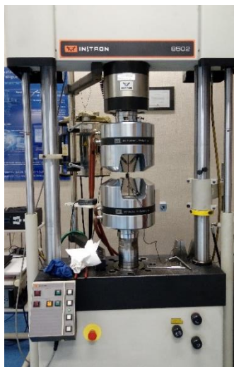
Rys. 3.11. Stanowisko badawcze: a) maszyna wytrzymałościowa, b) kamera BASLER acA4024-8gm do pomiaru odkształcenia
