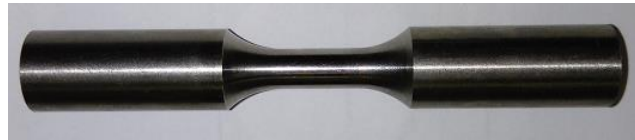
Rys. 3.3. Postać fizyczna próbki do badań w warunkach obciążeń statycznych i zmiennych wykonanych z pręta ciągnionego
