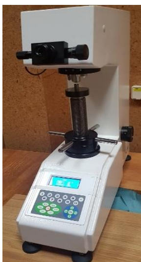
Rys. 3.19. Twardościomierz HUATEC HV-10: a) widok przyrządu, b) widok próbki podczas badań
