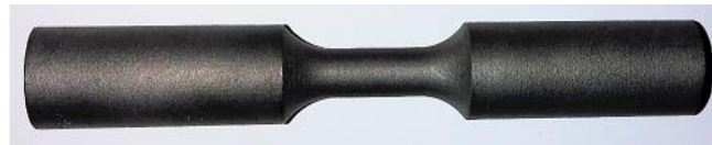
Rys. 3.4. Postać fizyczna próbki do badań w warunkach obciążeń statycznych i zmiennych wykonanych technologią DMLS
