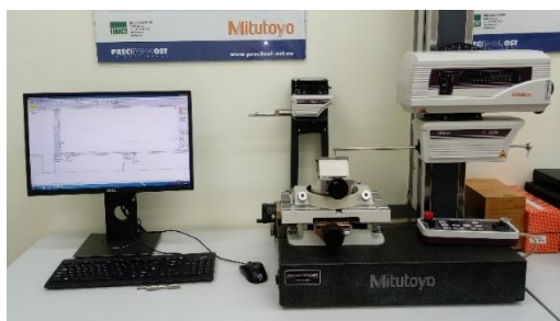
Rys. 3.6. Stanowisko do pomiarów geometrycznych Mitutoyo Formtracer SV-C3200
