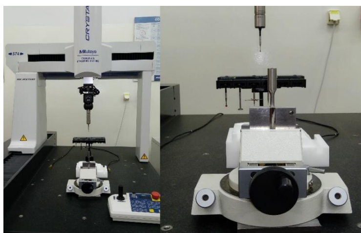
Rys. 3.8. Stanowisko do pomiaru okrągłości Mitutoyo CRYSTA-APEX S574
