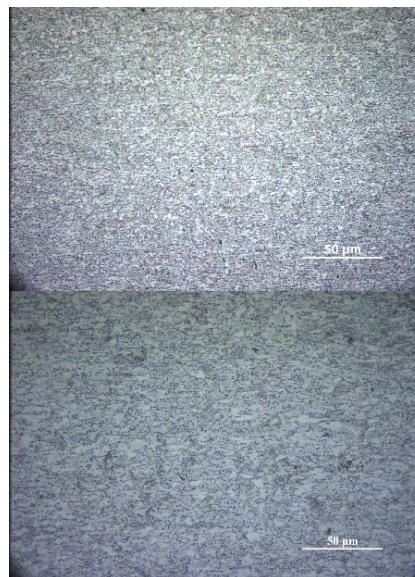
Rys. 3.22. Makro- i mikrostruktura próbki wykonanej z pręta z materiału Ti6Al4V pobrana wzdłuż osi Z w punkcie przed badaniami (Próbka PC-1): a) makrostruktura fragmentu próbki, b) mikrostruktura w powiększeniu x200, c) mikrostruktura w powiększeniu x500
