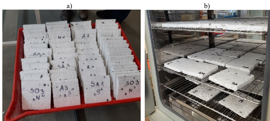
Rysunek 51. Ocena zawilgocenia styropianu a) przygotowane paski styropianu, b) suszenie próbek do stałej masy (archiwum własne)
