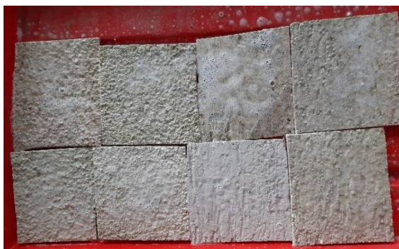
Rysunek 38. Czyszczenie próbek przy użyciu biocydu (archiwum własne)
