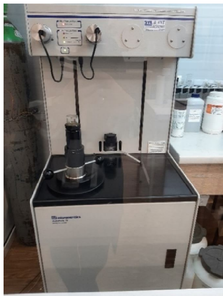
Rysunek 48. Badania mikrostruktury w porozymetrze AutoPore IV seria 9500 (archiwum własne)
