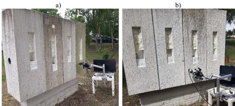
Rysunek 44. Stanowisko poligonowe na terenie kampusu Politechniki Bydgoskiej w trakcie badań mikroskopem Keyence Seria VHX-7000 a) orientacja N, b) orientacja S (archiwum własne)
