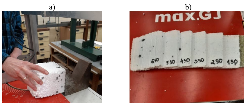
Rysunek 42. Przygotowanie próbek do badań a) cięcie materiału izolacyjnego, b) podzielona próbka badawcza (archiwum własne)
