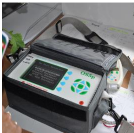
Fot. 16. Fluorymetr modułowany OS5p
