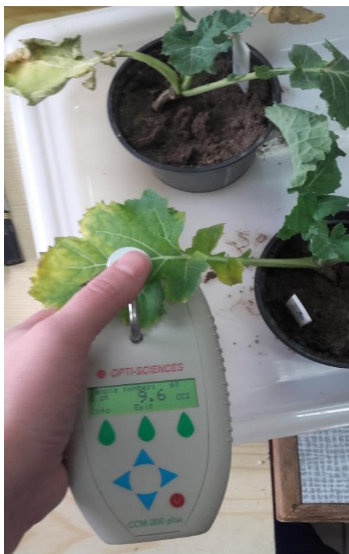
Fot. 18. Chlorofilomierz ADC: OSI CCM-200 Plus
