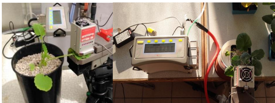
Fot. 15. System LCpro-SD z komorą klimatyzowaną
