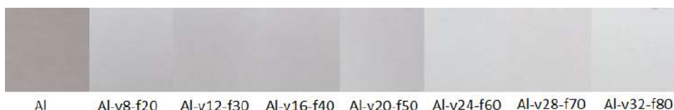
Rysunek 46: Fotografie otrzymanego aluminium oraz laserowo zmodyfikowanych warstw.
