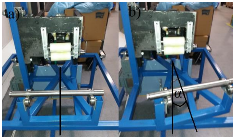
Rys. 6.16. Zmiana ustawienia kąta podawania materiału: a) kąt cięcia równy 0^\circ , b) kąt cięcia równy 10^\circ ,
