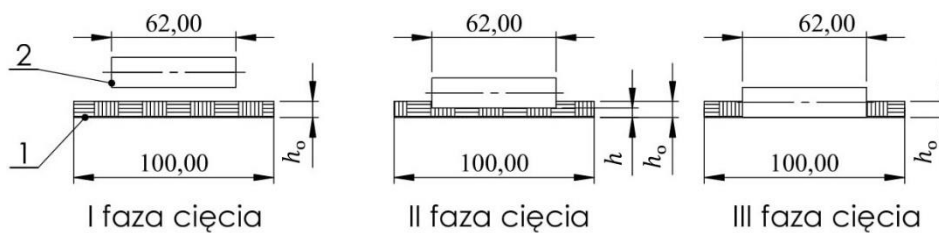
Rys. 4.5. Proces cięcia warstwy włókniny z podziałem na fazy dla kąta równego 0^\circ pomiędzy krawędzią tnącą a warstwą materiału przecinanego: a) I faza obejmuje zbliżanie się krawędzi noża do warstwy, b) II faza obejmuje zagęszczanie i zgniatanie warstwy, c) III faza obejmuje przecinanie warstwy materiału;
