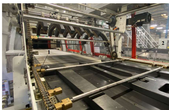
Rys. 19. Moduł zawijający: 1 – linia łańcuchowa ze zderzakami pozycjonującymi, 2 – przenośnik taśmowy (materiały własne)
