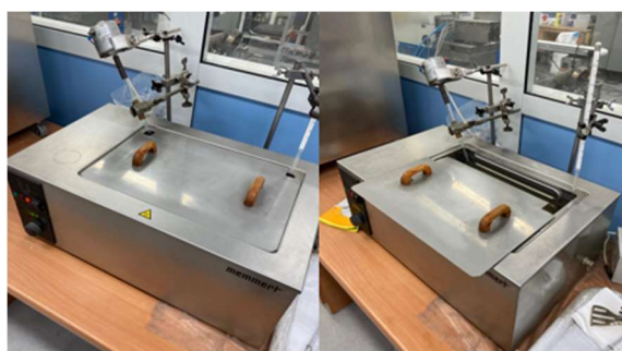
Rys. 25. Maszyna Memmert z misą wraz z olejem silikonowym (materiały własne)
