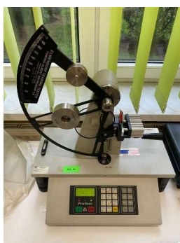
Rys. 30. Maszyna Pro Tear Tearing Tester, Twing-Albert Instrument Co podczas przeprowadzania badania wytrzymałości na rozdieranie (materiały własne)
