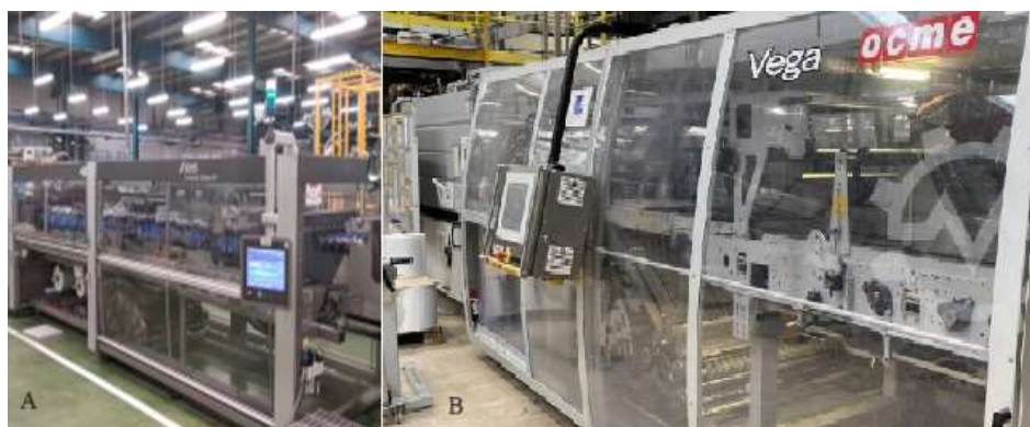
Rys. 3. Linie technologiczne masowego pakowania butelek poddane analizie, A – pakowarka SP A-M, B – pakowarka VEGA HT100 (materiały własne)
