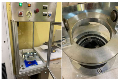
Rys. 27. Przyrząd do przeprowadzenia badania odporności próbek folii na uderzenie za pomocą spadającego grotu (materiały własne)
