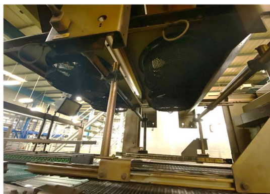
Rys. 13. Wentylatory na wyjściu z pieca grzewczego (materiały własne)
