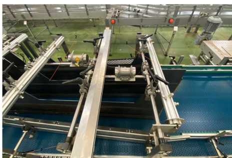
Rys. 7. Elementy modułu doprowadzającego: 1 – taśma gumowa, 2 – dźwignia wychylna, 3 – zespół przestawiania wysokości dźwigni (materiały własne)
