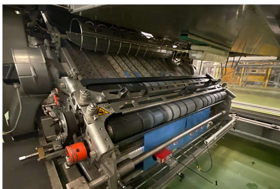
Rys. 11. Trzpienie do mocowania rolek folii: 1– czujniki laserowe do rozpoznawania końcówki folii (materiały własne)
