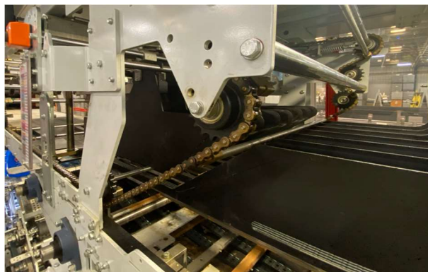
Rys. 17. Zespół pakowarki odpowiedzialny za przetransportowanie butelek do strefy owijania (materiały własne)
