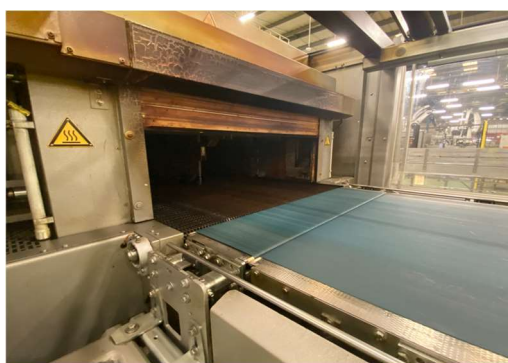
Rys. 12. Tunel obkurczania z przenośnikiem taśmowym z plecionki stalowej w jego wnętrzu (materiały własne)
