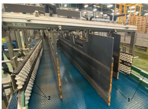
Rys. 6. Schemat modułu doprowadzającego z zaznaczonymi prowadnicami szynowymi – 1 oraz bazami wibratorów liniowych – 2 (materiały własne)
