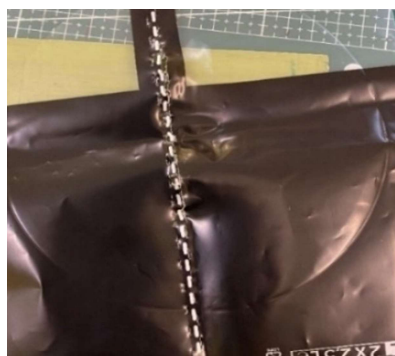
Rys. 28. Przykład nacięć na folii wykonanych przez producenta uniemożliwiających wycięcie próbek do badań (materiały własne)
