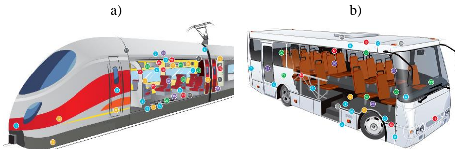
Rys. 2.5. Wykorzystanie połączeń adhezyjnych w produkcji [W2]: a - pojazdów szynowych, b - autobusów
