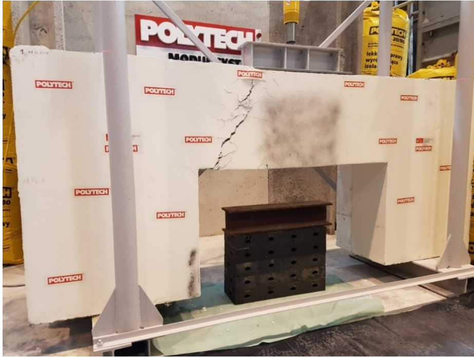
Fot. 7.5. Badany element po zniszczeniu w rezultacie przyłożenia obciążenia
