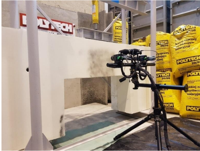
Fot. 8.3. Urządzenie pomiarowe „ARAMIS” podczas badań wytrzymałościowych nadproża wykonanego w systemie prefabrykacji „POLYTECH”
