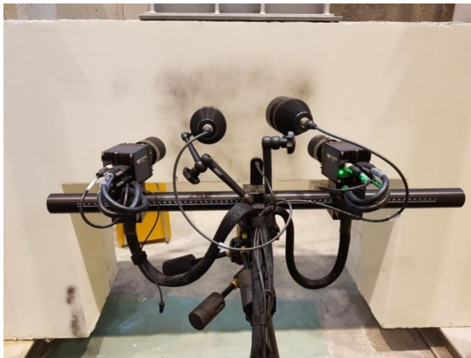
Fot. 8.2. Urządzenie pomiarowe „ARAMIS” podczas badań wytrzymałościowych nadproża wykonanego w systemie prefabrykacji „POLYTECH”
