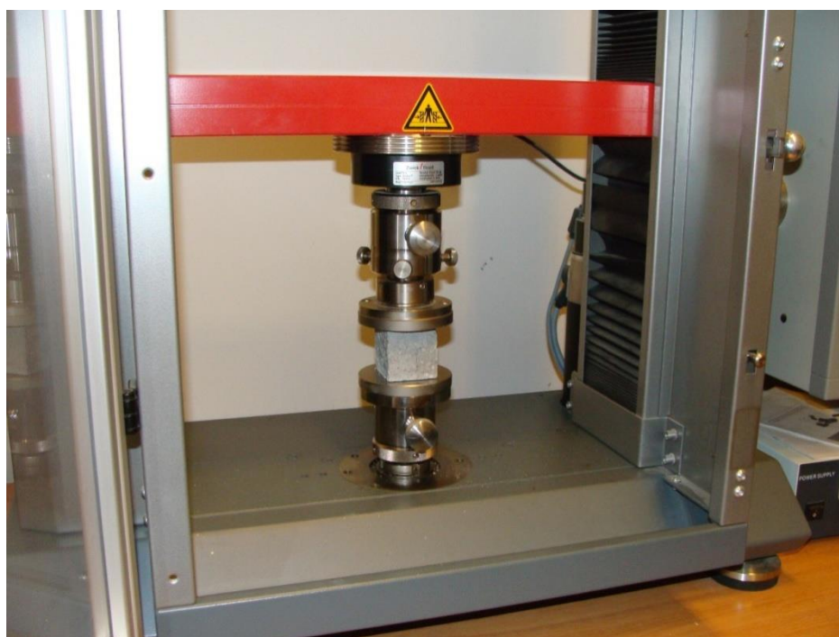
Fot. 7.1. Badanie wytrzymałości na ściskanie próbek wykonanych z materiału „POLYTECH” z wykorzystaniem maszyny wytrzymałościowej Zwick 020 GmbH klasy „0,5”
