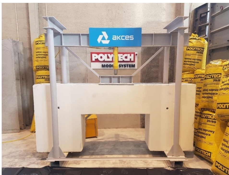
Fot. 7.4. Obiekt badań na stanowisku badawczo pomiarowym (urządzenie ściskające)
