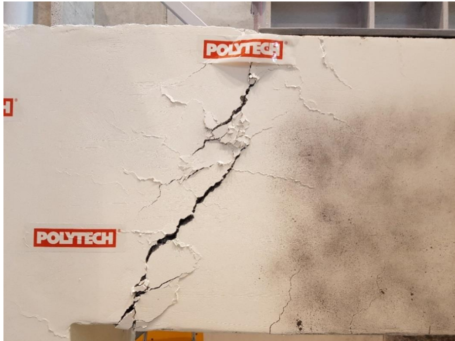
Fot. 7.6. Fragment badanego elementu po zniszczeniu w rezultacie przyłożenia obciążenia
