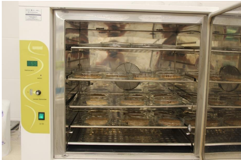
Fot. A8. Oznaczanie zawartości suchej masy w bulwach ziemniaka – Suszarka z wymuszonym obiegiem powietrza (SUP-100W, Warmed,Polska)
