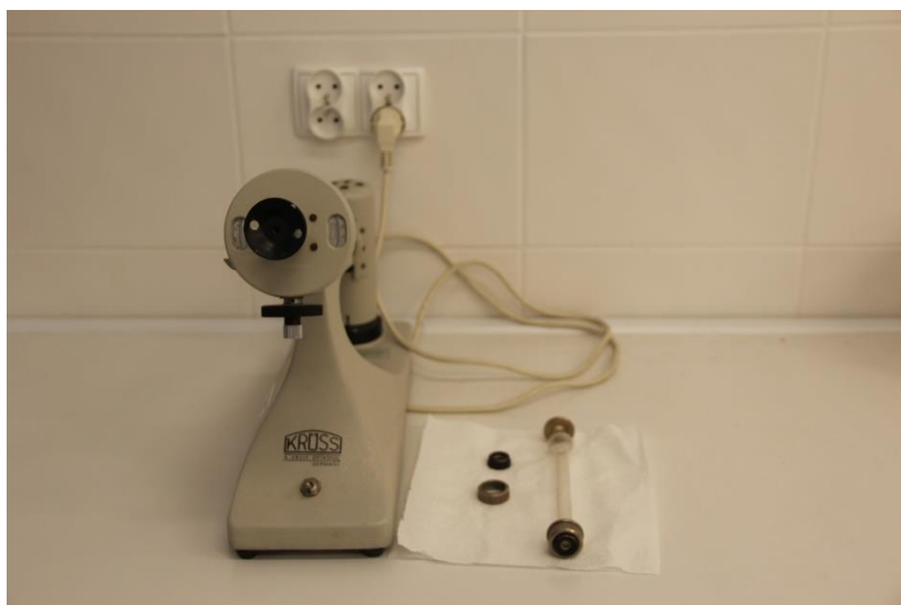
Fot. A10. Oznaczanie zawartości skrobi w bulwach ziemniaka – Polarymetr P1200 (Krüss Optronic, Niemcy)
