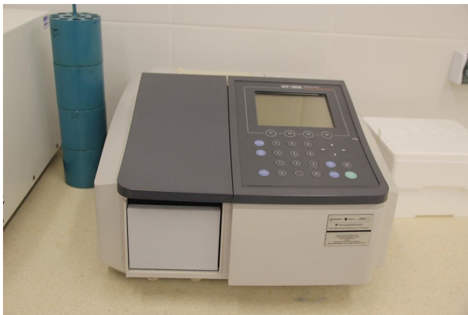
Fot. A15. Oznaczenie zawartości cukrów redukujących i ogółem w bulwach ziemniaka - Spektrofotometr SHIMADZU UV-1800 (Japonia)
