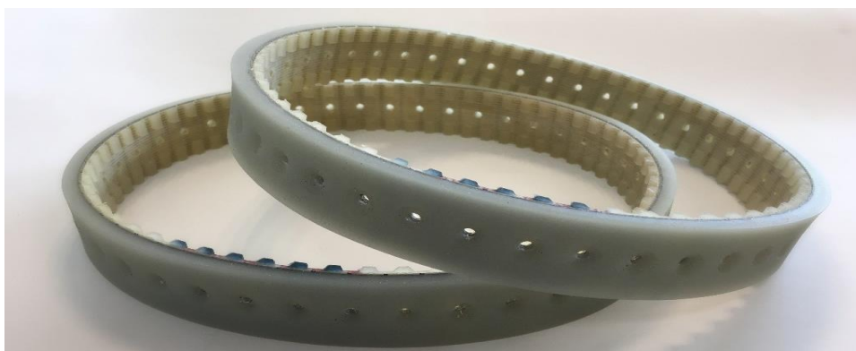
Rys. 21. Pas zębata bezkońcowy poliuretanowy z pokryciem silikonowym dodatkowo z otworami stożkowymi oraz frez w osi zębów, stosowany w maszynach pakujących z systemem podciśnieniowym typu „vacuum”.
