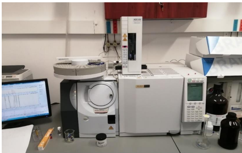
Fot. 10. Chromatograf gazowy użyty w badaniach składu kwasów tłuszczowych i fitosteroli (GC-MS QP2010 PLUS) (fot. W. Pilarski).
