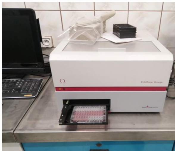
Fot. 12. Spektrofotometr (FLUOstar Omega, BMG LABTECH) użyty w badaniach zawartości związków fenolowych ogółem, flawonoidów i potencjału przeciwutleniającego (fot. W. Pilarski).
