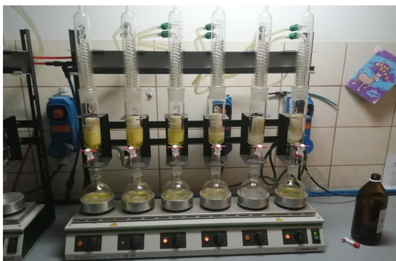
Fot. 9. Aparat Soxhleta w trakcie ekstrakcji tłuszczu z nasion komosy ryżowej (fot. W. Pilarski).
