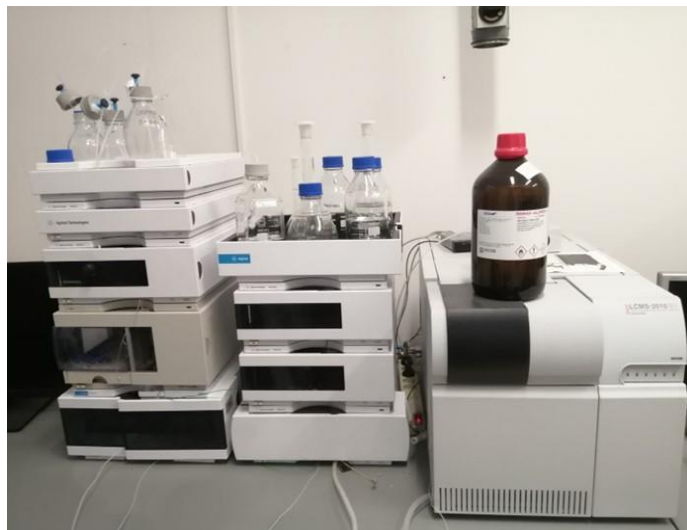
Fot. 11. Chromatograf cieczowy użyty w badaniach tokoli, karotenoidów i skwalenu (HPLC Agilent Technologies 1200) (fot. W. Pilariski).
