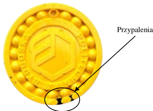
Rys. 13. Wypraska typu medal promocyjny Politechniki Bydgoskiej, z widocznymi przypaleniami na końcu drogi płynięcia, charakterystycznymi dla tzw. „Efektu Diesla”. Opracowanie własne
