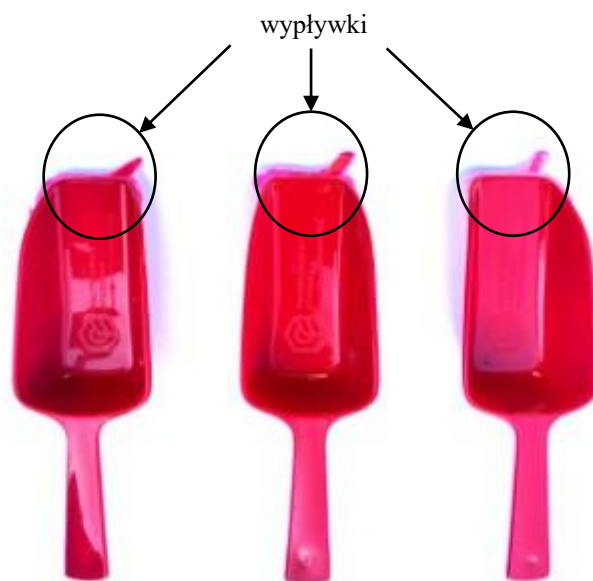
Rys. 11. Wypływkę charakterystyczne dla uszkodzonych płyt formujących, na przykładzie wyprasek typu łopatka do cukru, wytworzonych w trzech kolejnych cyklach produkcyjnych. Opracowanie własne
