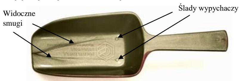
Rys. 14. Wypraska typu łopatką do cukru z widocznymi smugami, powstałymi na skutek zakłóceń przepływu tworzywa podczas wypełniania gniazda formującego. Opracowanie własne
