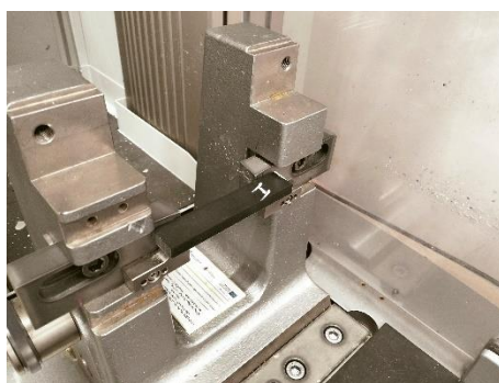
Rys. 41. Przykładowa próbka PA66GF30 przygotowana do badania udarności
