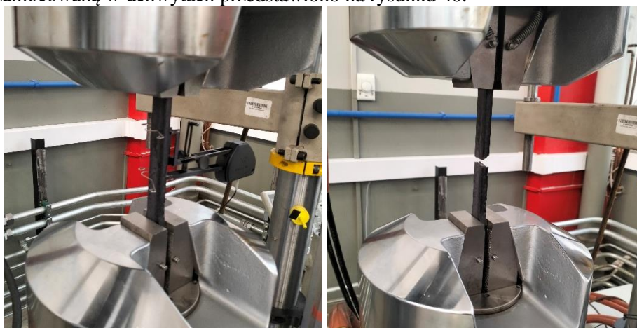
Rys. 40. Próbkę PA66GF30 o grubości 8,4 mm przed rozpoczęciem statycznej próby rozciągania (po lewej) oraz po zerwaniu (po prawej)
