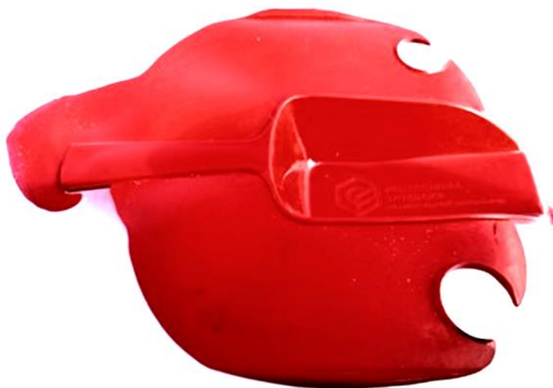
Rys. 12. Przykładowy obraz cienkościennej wypraski o dużej powierzchni typu łopatka, z wypływką powstałą na skutek zastosowania zbyt dużej objętości wtrysku i ciśnienia sprężania. Opracowanie własne
