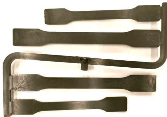
Rys. 26. Widok wypraski z PA66GF30, uzyskanej w procesie wtryskiwania mikroporującego przy zastosowaniu parametrów przedstawionych w tabeli 1
