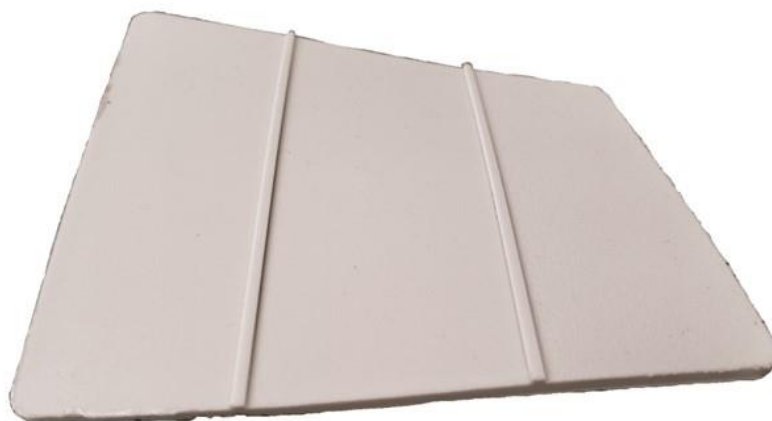
Rys. 15. Przykład wypraski z polipropylenu z widocznymi deformacjami kształtu na skutek anizotropii skurczowej, których źródłem była zmienna grubość ścian wyprasek. Opracowanie własne
