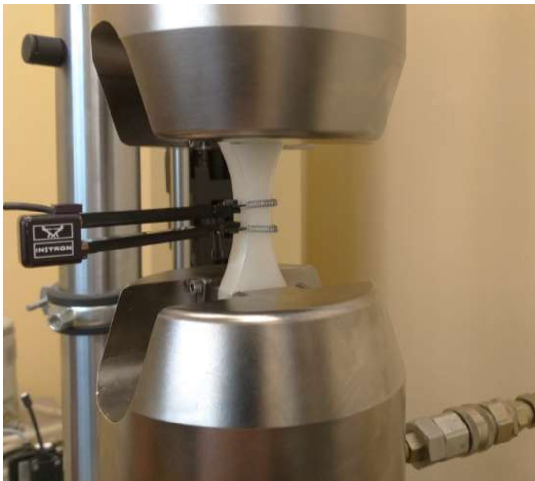
Rys. 19. Próbką zamocowaną w szczękach maszyny wytrzymałościowej INSTRON 8874, wraz z zamontowanym ekstensometrem.
