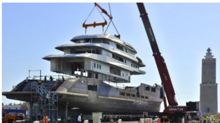
Rys. 2.7. Nakładanie nadbudowy ze stopu aluminium na stalowy kadłub, Benetti Superjacht FB273 [60]
