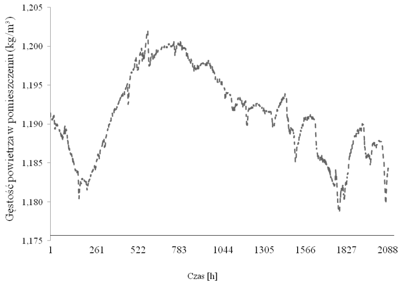
Rys.44. Pomiar gęstości powietrza wentylacyjnego w analizowanym pomieszczeniu
