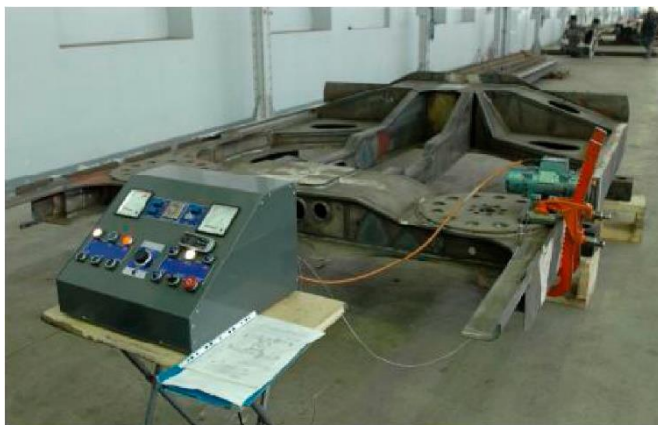
Rys. 6. Stanowisko do odprężania czołownicy pojazdu szynowego
